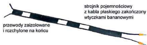
Rys. 2. Kondensator dostrojczy wykonany z kabla drabinkowego
