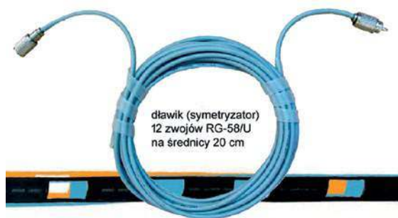
Symetryzator ze zwiniętego kabla koncentrycznego
