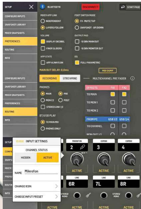
W panelu konfiguracji Flow Mix mamy dostęp do wielu funkcji miksera, w tym do komutacji, ustawień kanałów i trybów pracy.
