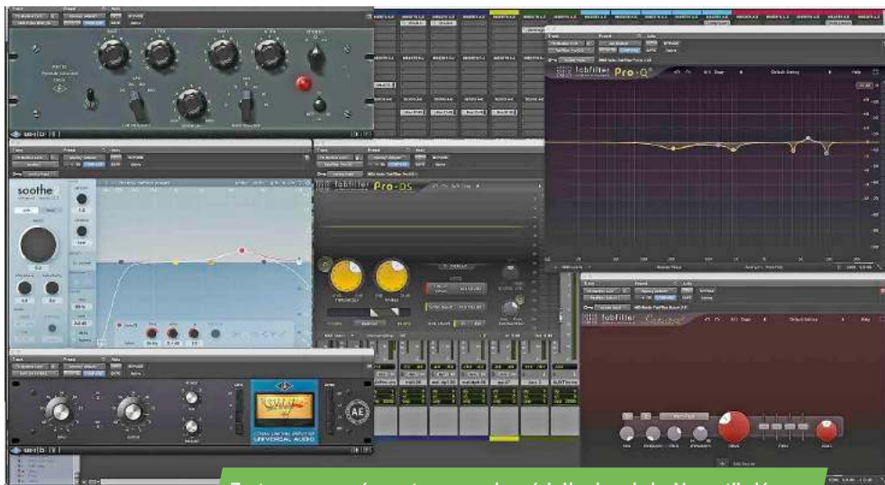
Zestaw procesorów zastosowanych na ścieżkach wokalu. Na partii głównej pracują: UAD Pultec EQP-1A, Oeksound Soothe, UAD 1176AE, FabFilter Pro-Q3, FabFilter Pro-DS i FabFilter Saturn2.
