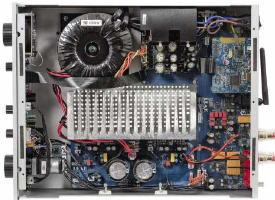
Niewielka obudowa to pokusa do zastosowania układów impulsowych, ale w Stereo 230 są tylko układy liniowe - zrealizowane na układach scalonych.
