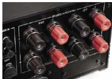
Masywne i wygodne zaciski głośnikowe tworzą dwa zestawy, można je załączać w różnych konfiguracjach.
