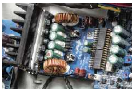
Układy impulsowe ponownie kupiono od Hypexa.
