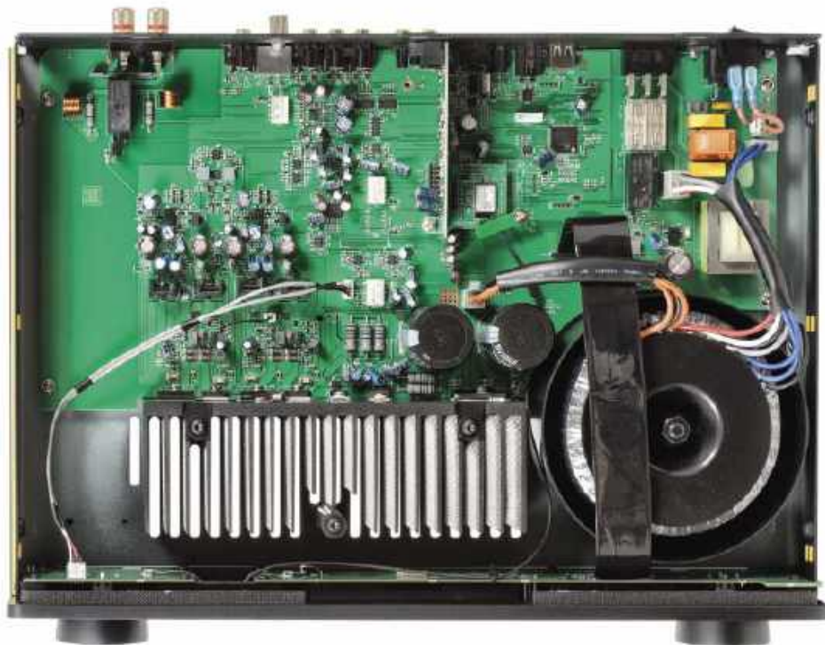
Cały tor sygnału utrzymano na jednej dużej płycie drukowanej – z wyjątkiem wyjścia słuchawkowego.
