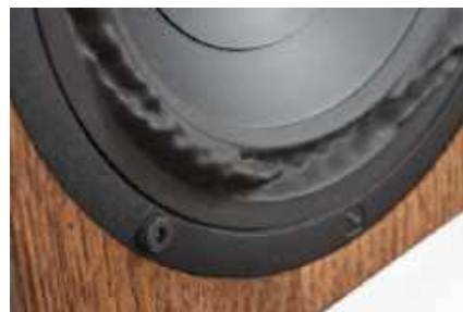
Głośnik nisko-średniotonowy Purify ma charakterystyczne dla tej firmy, "pomarszczone" górne zawieszenie.
