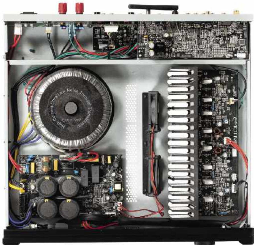
Wnętrze podzielono metalowym ekranem na dwie komory. W przedniej znajduje się zasilacz (liniowy) oraz końcówki mocy (pracujące w klasie AB), w tylnej – pozostałe układy.
