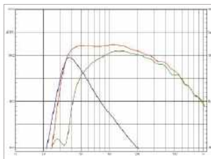
rys. 2. Charakterystyki źródeł niskich częstotliwości (do 200 Hz).
