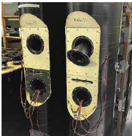
Obudowa przed założeniem tylnych żaluzji – dobrze widać zarówno tunele bas-refleks, jak i szczelinę komory średnionowej.
