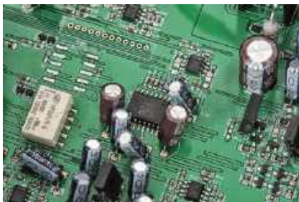
Regulacja głośności jest prowadzona w scalonym tłumiku Burr Brown.
