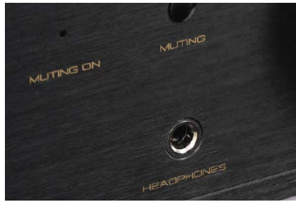
Jest wyjście słuchawkowe, chociaż bez dedykowanego układu wzmacniającego.
