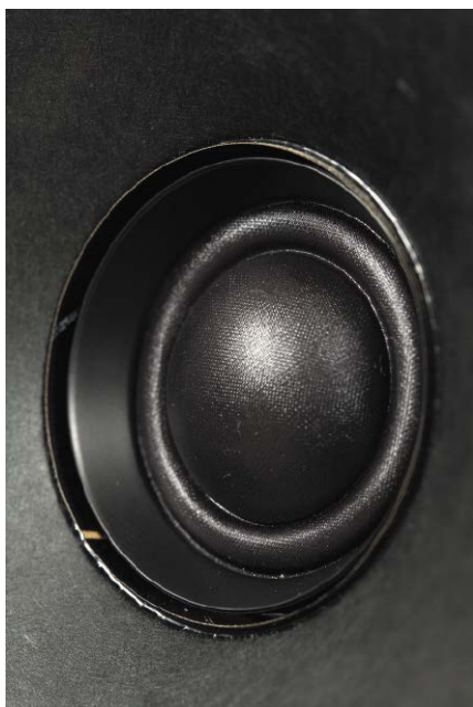
32-mm tekstylna kopułka wysokotonowa w falowodzie utworzonym przez krótki kołnierz i stożek membrany średniotonowej pracuje od 1,4 kHz.
