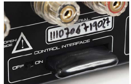
Pod plastikową kapsułą kryje się część układów Wi-Fi, które można wyłączyć.
