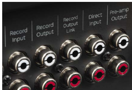
Aethos ma za to sporo dodatkowych gniazd liniowych, w ramach pętli dla rejestratora przygotowano aż dwa równoległe wyjścia.
