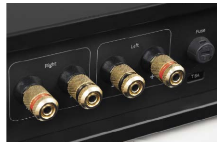
Rega we wszystkich wzmacniaczach montuje wyłącznie pojedyncze terminale głośnikowe.
