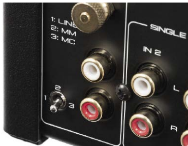
Wejście gramofonowe można skonfigurować do pracy w trybie MM lub MC. Albo przełączyć je w tryb liniowy.
