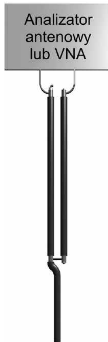
Rys. 8. Pomiar indukcyjności i rezystancji szeregowej dopasowania Karo wykonanego z równoległych kabli dla dużych impedancji
