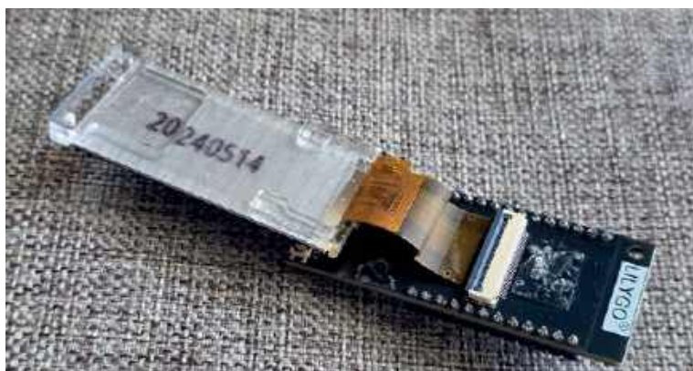
Moduł sprzedawany jest bez wlotowanych gold-pinów, może zająć konieczność, by do wlotowania gold-pinów do płytki ESP32-S3 odchylić wyświetlacz przyklejony do płytki
