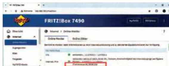
Rys. 3. Odczyt adresu IP modemu dostępowego w jego konfiguracji na przykładzie modelu FRITZ!Box 7490
