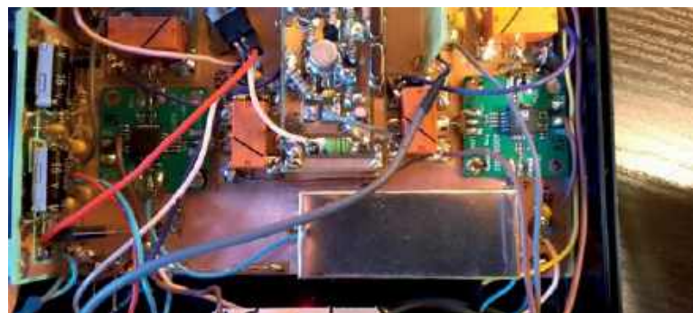
Widok modułów mieszaczy i filtra kwarcowego w metalowym ekranie
