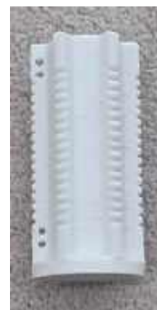
Karkas cewki generatora wydrukowany na drukarce 3D
