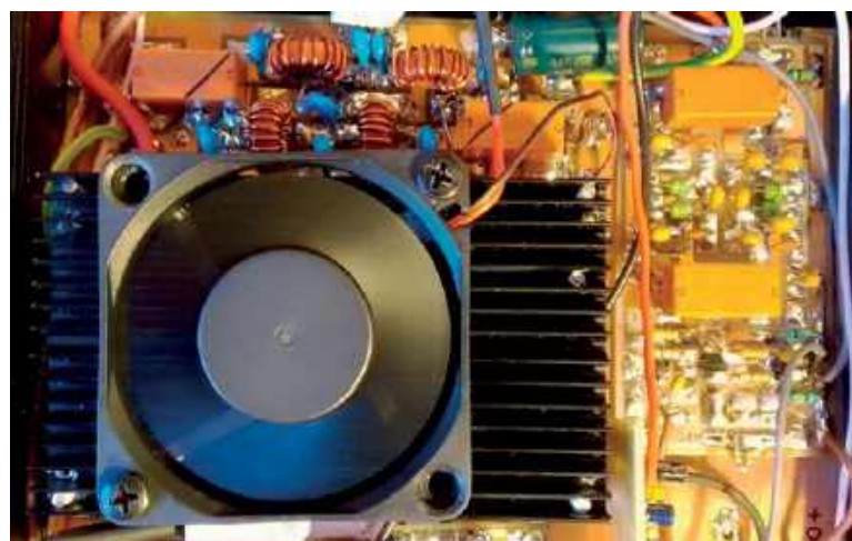
Widok wzmacniacza mocy 30 W z wentylatorem oraz filtrów wyjściowych i obwodów wejściowych dla dwóch pasm
