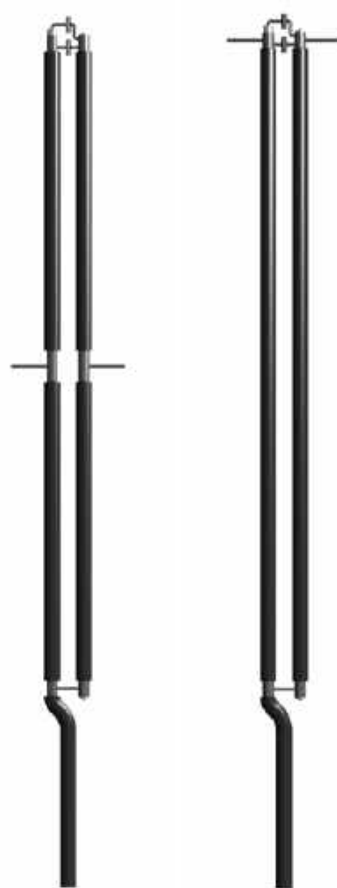
Rys. 7. Zmodyfikowane dopasowanie Karo z kablami poprowadzonymi równoległe.
