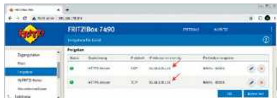
Rys. 4. Przekierowywanie kanałów logicznych
