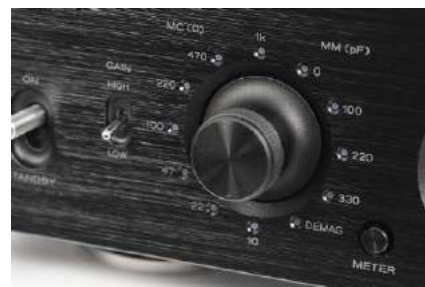
Wielofunkcyjnym pokrętkiem ustawiamy obciążenie (impedancję i pojemność), a system automatycznie dopasowuje poziom wzmocnienia.
