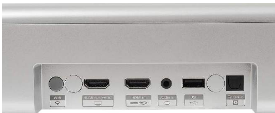
Oprócz wyjścia HDMI (z eARC) jest też wejście, a ponadto złącza optyczne, analogowe oraz USB (dla plików z nośników).
