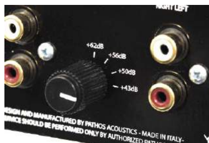
Regulację wzmocnienia umieszczono na tylnej ścianie.
