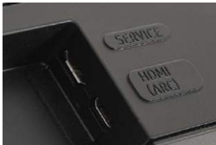
Panel przyłączeniowy jest wyjątkowo skromny – ogranicza się do jednego HDMI.
