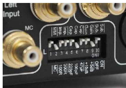
Mikroprzełączniki odpowiadają za większość ustawień, choć operowanie małeńkimi hebelkami nie należy do najłatwiejszych.
