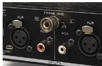
PE-505 przyjmuje sygnały symetryczne z wkładki pod warunkiem, że skorzystamy z wejść XLR (nawet jeśli gramofon ma RCA, to możemy zastosować przejściówkę).
