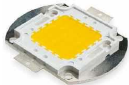
Fotografia 6. Biała dioda LED 100 W. Składa się z wielu diod mniejszej mocy połączonych w układzie równoległych łańcuchów szeregowo łączonych diod. Całość jest zalana luminoforem i zabezpieczona tworzywem sztucznym
