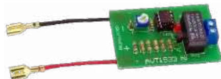
AVT1533 Zabezpieczenie akumulatora 12 V przed rozładowaniem https://sklep.avt.pl/avt1533.html
