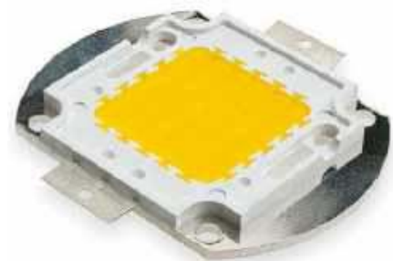
Fotografia 6. Biała dioda LED 100 W. Składa się z wielu diod mniejszej mocy połączonych w układzie równoległych łańcuchów szeregowo łączy diod. Całość jest zalana luminoforem i zabezpieczona tworzywem sztucznym
