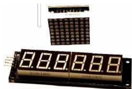
Fotografia 3. Gotowe, chińskie moduły wyświetlacza siedmiosegmentowego i matrycy LED 8×8
