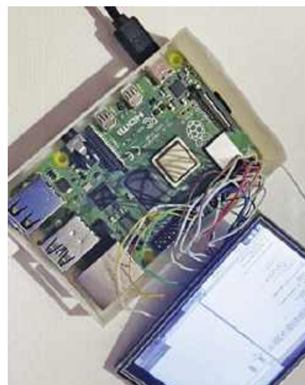
Rysunek 11. Podłączanie wyświetlacza SPI do Raspberry Pi
