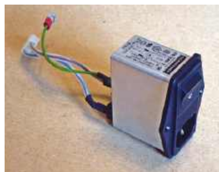
Rysunek 5.9. Złącze sieciowe IEC ze zintegrowanym filtrem EMI
