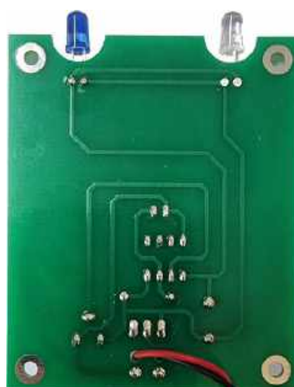
Fotografia 15. Poprawnie zmontowany układ Termo Strażaka. Widok płytki a) od strony komponentów, b) od strony lutowania
