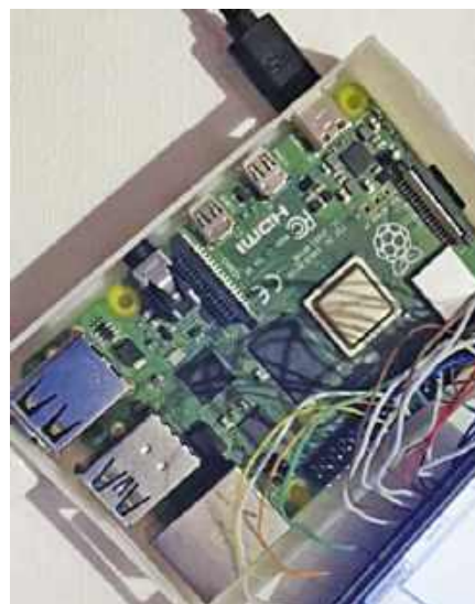
Rysunek 17. Raspberry Pi zamontowane w obudowie
