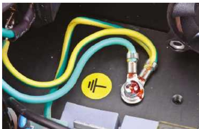
Rysunek 5.4. Dla zachowania zgodności z przepisami EMC decydujące może być prawidłowe uziemienie metalowej obudowy
