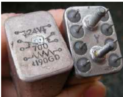
Rysunek 9. Hermetycznie zamknięte przełączniki 4190 firmy STC do przelączania sygnałów audio. Mają sprawdzoną żywotność około 30 lat. Takie przełączniki można rozpoznać po szklanych przepustach wokół styków
