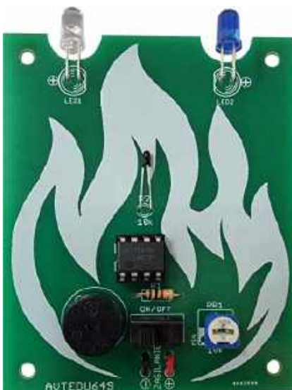
Fotografia 15. Poprawnie zmontowany układ Termo Strażaka. Widok płytki a) od strony komponentów, b) od strony lutowania
