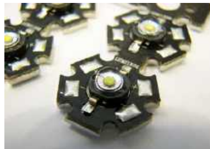
Fotografia 5. Diody 1 W na aluminiowym nośniku, który można przykręcić do radiatora
