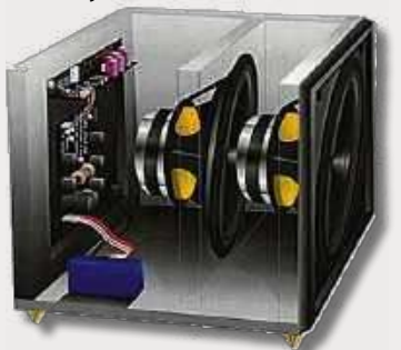
Rysunek 3. Układ izobaryczny ma dwa głośniki połączone szeregowo, sterowane tym samym sygnałem
