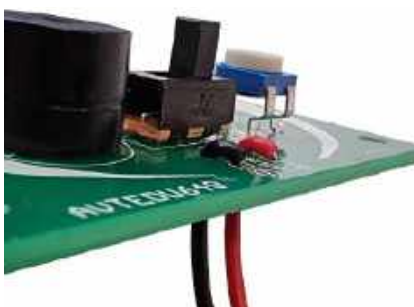
Fotografia 14. Kabelki złącza baterii należy przeprowadzić w otwory pomocnicze od strony lutowania a następnie odizolować końcówki przewodów należy umieścić w otworach zgodnie z fotografią 13 i przylutować
