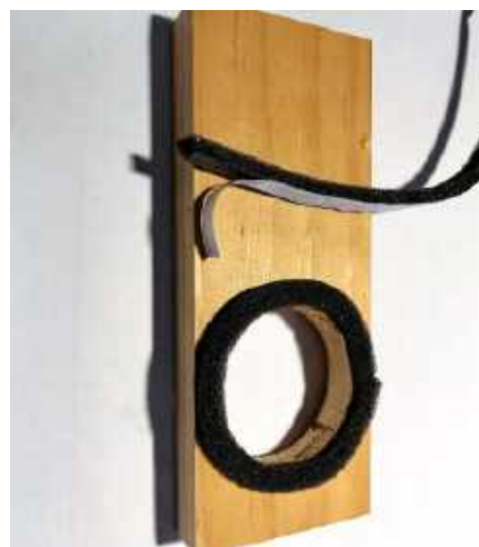
Wszystkie głośniki muszą być uszczelnione za pomocą samoprzylepnej uszczelki piankowej
