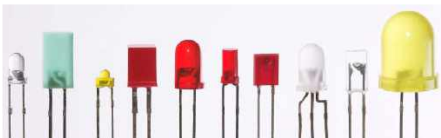
Fotografia 1. Najpopularniejsze kształty i rozmiary diod LED do montażu przewlekanego
