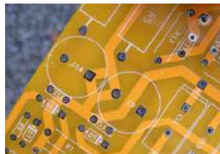
Rysunek 4. Niski poziom tętnień jest zapewniony przez staranne poprowadzenie ścieżek. Projektant płytek Mike Grindle zastosował tutaj specjalne łączenie mas „w gwiazdę”, aby oddzielić masę prostownika, „czystą” masę zasilania i potencjał odniesienia 0 V
