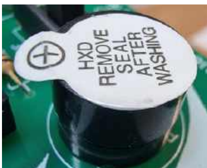
Fotografia 12. Naklejka zabezpieczająca na czas transportu i montażu wewnątrz buzzera przed zanieczyszczeniami. Należy ją odkleić, w przeciwnym razie generowany dźwięk będzie mocno zagłuszony
