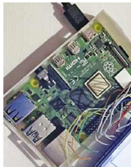
Rysunek 17. Raspberry Pi zamontowane w obudowie
