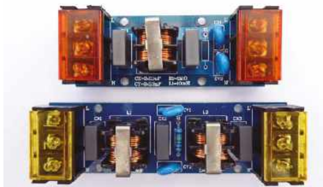
Rysunek 5.6. Typowe filtry zasilania: jedno i dwustopniowy
