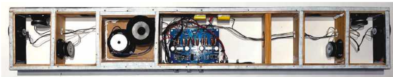
Moduł wzmacniacza włącznie z gniazdem wejściowym 3,5 mm jest montowany w otworze tylnego panelu za pomocą pustego laminatu PCB. W zestawie znajduje się przetątnik wyboru dla opcjonalnego zewnętrznego subwoofera i gniazdo zasilania 12...24 V. Gniazda bananowe są przeznaczone dla zewnętrznego subwoofera. Całe okablowanie należy unieruchomić za pomocą opasek zaciskowych i uszczelnacza silikonowego, aby zapobiec niepożądanym wibracjom
