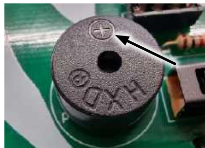
Fotografia 11a. Nadrukowana białą farbą na płytce PCB znak „+” wskazuje otwór w który należy zamontować „plusowe” wyprowadzenie buzzera aktywnego; b) znak „+” wskazujący lokalizację „plusowego” wyprowadzenia jest również wytłoczony w obudowie buzzera aktywnego, dotychczasowego do zestawu. Na powyższych fotografiach oznaczenia bieguna „plusowego” wskazane zostały strzałką
