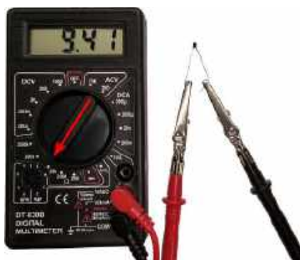
Fotografia 4. Pomiar chwilowej wartości rezystancji termistora w temperaturze pokojowej. Wartość rezystancji dla termistora 10 kΩ w temperaturze pokojowej (ok. 25°C) powinna być bliska jego znamionowej wartości (tu 10 kΩ). Rozgrzewanie termistora sprawi, że wskazywany wynik mierzonej rezystancji zacznie maleć
