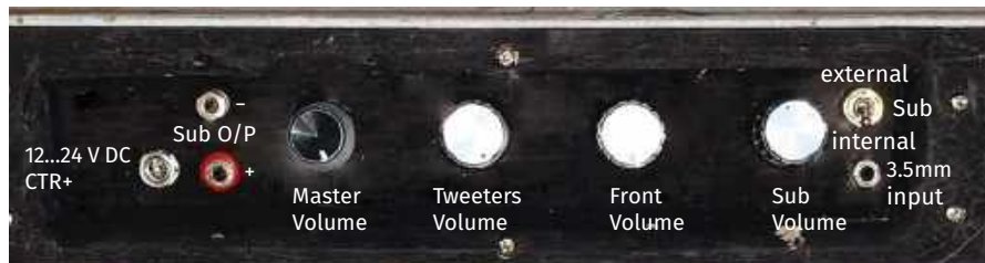
Panel sterowania dla isoundBara. Przydatne może być utworzenie własnej etykiety wyjaśniającej znaczenie poszczególnych elementów panelu
