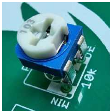
Fotografia 10. Poprawnie zamontowany potencjometr PR1
