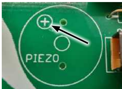
Fotografia 11a. Nadrukowana białą farbą na płytce PCB znak „+” wskazuje otwór w który należy zamontować „plusowe” wyprowadzenie buzzera aktywnego; b) znak „+” wskazujący lokalizację „plusowego” wyprowadzenia jest również wytłoczony w obudowie buzzera aktywnego, dotychczasowego do zestawu. Na powyższych fotografiach oznaczenia bieguna „plusowego” wskazane zostały strzałką
