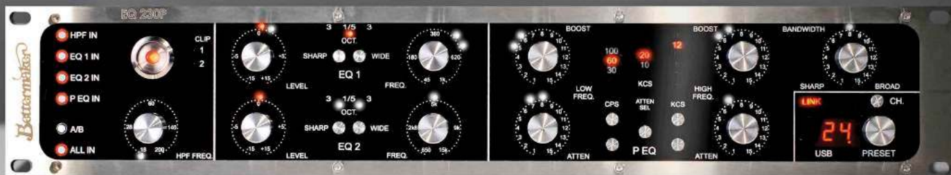
Oryginalny, zaprezentowany w 2011 roku analogowy korektor ze sterowaniem cyfrowym, obecnie już nieprodukowany Bettermaker EQ230P. Wtyczka Bettermaker EQ232D jest jego emulacją, poszerzoną o możliwość pracy w trybie Mid-Side.
