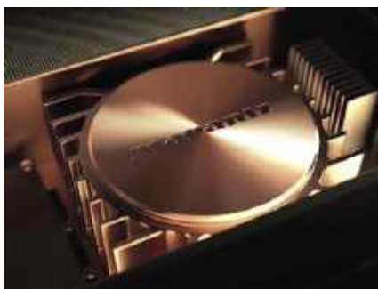
Miedzianą osłonę transformatora zintegrowano z radiatorem.
