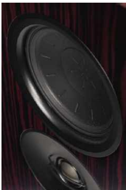
Dwie średniotonowe 12-tki razem z wysokotonowym tworzą świetnie zgrany układ symetryczny; przejście przez częstotliwość podziału jest idealnie płynne, i to nie tylko na osi głównej.
