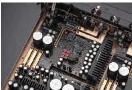
Model 10 wykorzystuje zmodyfikowane moduły impulsowych końcówek Purifi.
