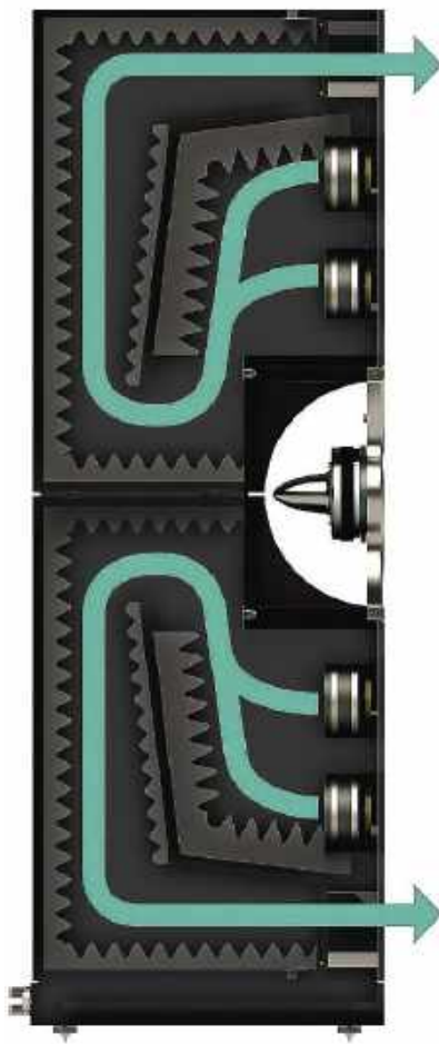
Flagowiec PMC – Fenestria . Dwie bliźniacze sekcje niskotonowe (każda z parą niskotonowych). Komora za głośnikami łączy się z dalszym biegiem kanału wyraźnym zmniejszeniem przekroju; to jednak często spotykane, natomiast nietypowe jest, że na drugim etapie kanał rozszerza się, aby zmniejszać dopiero na trzecim, ostatnim.
