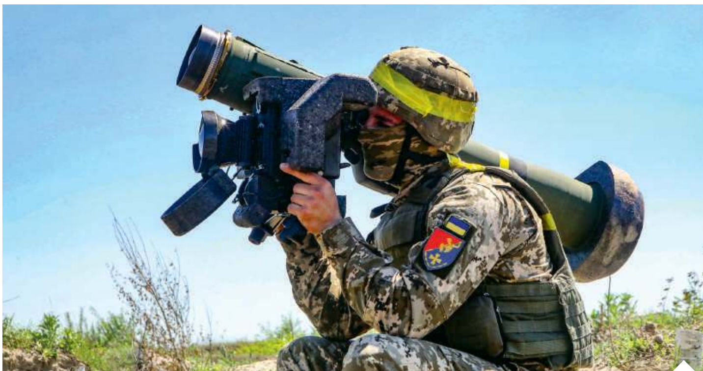
FGM-148 Javelin jest bronią typu „odpal i zapomnij” (F&F), zdolną do niszczenia opancerzonych celów na odległość do 2,5 km | fot. Volodymyr Tarasov/Ukrinform/ddp images/Forum
