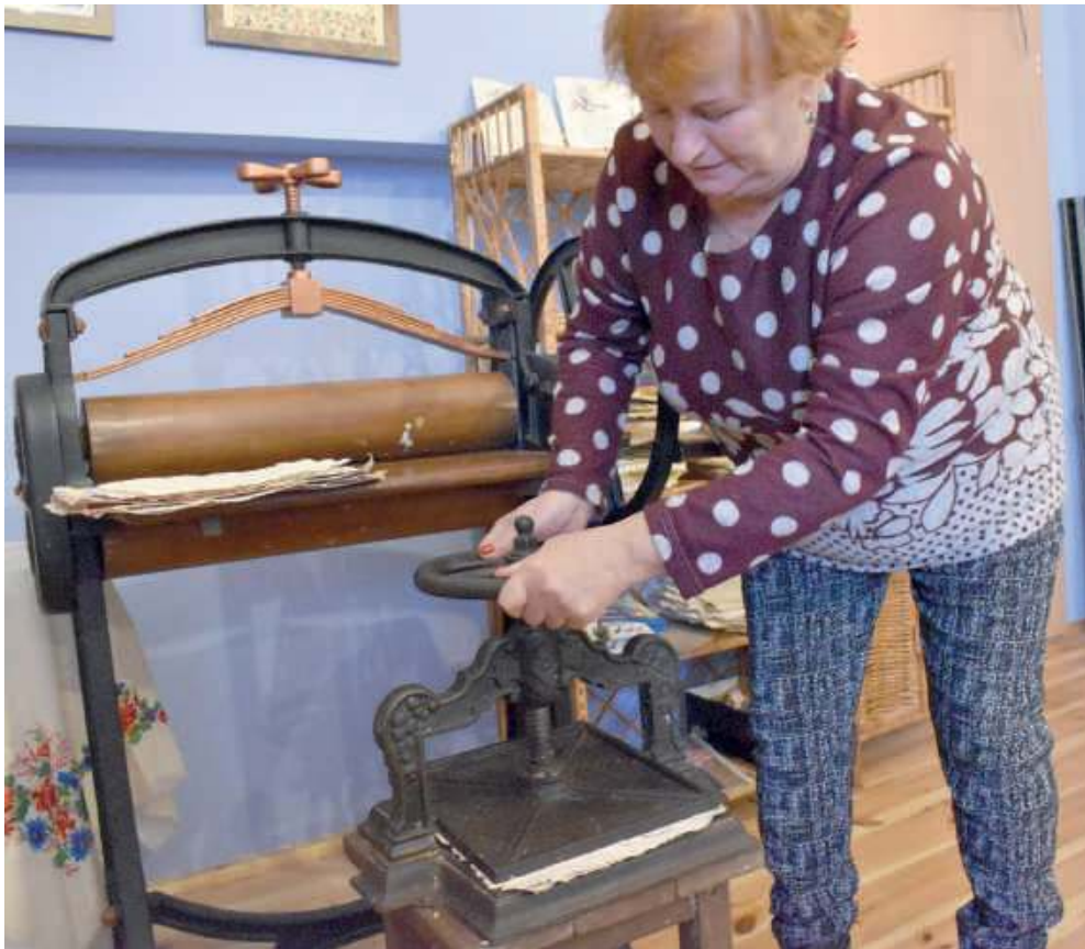
Pulpę z materiałem umieszcza się na deseczce, a następnie wyciska się w prasie. Po wysuszeniu papier trzeba jeszcze wyprasować w maglownicy (urządzenie za prasą)
