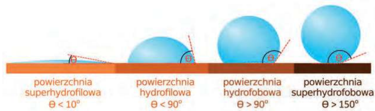
Rys. 6. Kąty zwilżania dla kropli wody umieszczonej na podłożach o odmiennych właściwościach.
