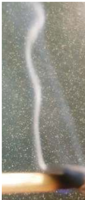
Rys. 7. Po lewej zdjęciu przedstawiają strumień wody płynącej z kranu. Po lewej strumień przepływa laminarnie, w spójnej strudze, obok na fotografii widać przepływ turbulentny, strumień jest niestabilny i zmienia swój kształt w nieprzewidywalny sposób. Po prawej. Dym unoszący się z gaszonego kawałka drewna. Początkowo, dym unosi się w jednolitej strudze, która wraz z unoszeniem się zmienia kształt i zaczyna się rozmywać w powietrzu.
