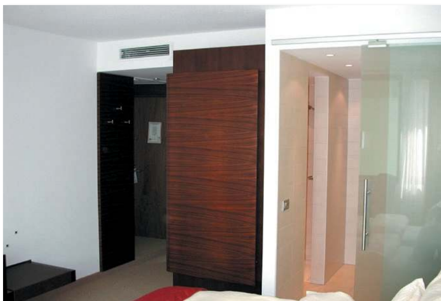
Fot. 1. Elementy instalacji wentylacyjnej (np. kratki nawiewne w pokoju hotelowym) nie mogą powodować nadmiernego przenikania dźwięków powietrznych z innych pomieszczeń Źródło: Schako
