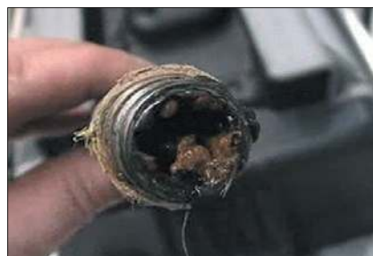
Rys. 4. Skrajny przykład biofilmu na końcu przewodu ze stagnującą wodą. Źródło: [23]
