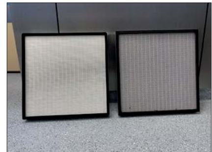
Fot. 5. Porównanie stanu filtra HEPA przed i po eksploatacji Źródło: archiwum autorki
