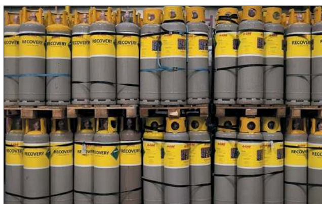
Fot. 2. Butle do odzysku (transportu i magazynowania) czynnika chłodniczego zebranego z pracującej instalacji chłodniczej Źródło: A-Gas
