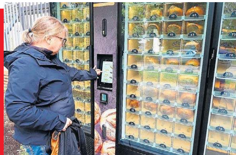
Na ekranie trzeba wybrać rodzaj pieczywa i zapłacić zbliżeniowo kartą. To zwalnia elektryczny zamek danej sekcji i otwiera wybraną szufladkę, z której wyjmujemy się pieczywo.
