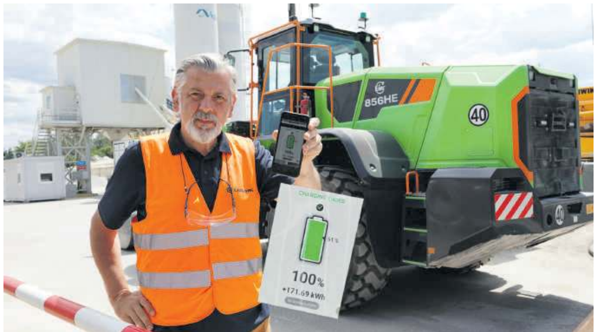
Kierownik sprzedaży w LDM, Jacek Staroń, przy pierwszej elektrycznej ładowarce Liugonga. Przy pomocy telefonu można sprawdzić stopień naładowania jej baterii – w tej chwili wskaźnik pokazywał 100 proc. (z poziomu 61 proc. została doładowana mocą 171,69 kWh)
