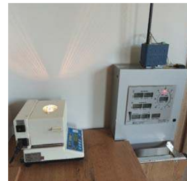
Pracująca wagosuszarka i umieszczony obok rejestrator danych pomiarowych
