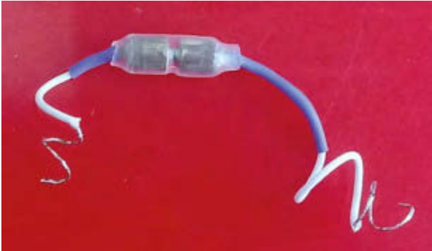
Fot. 5. Wygląd zewnętrzny elementu piezoelektrycznego, połączonego z elektrodami w sposób pokazany na rys. 2.
