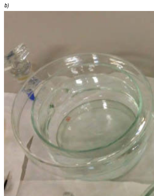
Rys. 5. a) naklejanie ramki z polimeru PDMS na powierzchni grafenu na miedzi, b) ramka z grafenem pływa w naczyniu podczas trawienia miedzi.
