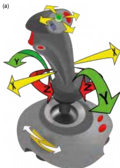
Rysunek 2. (a) Osie ruchu drążka dźojstika analogowego. (b) Widok mechanizmu dźojstika podczas maksymalnego wychylenia dźojstika w prawo i w tył (osie X i Y). https://pl.wikipedia.org/wiki/D%C5%BCojstik Dostęp 08.03.2021.
