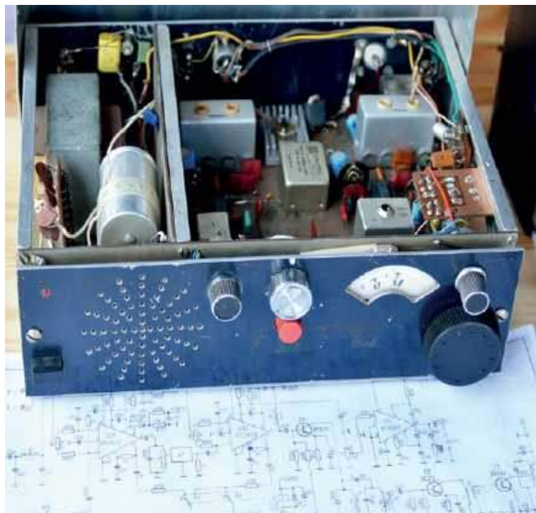
TRX Bartek z wbudowanym zasilaczem (lata 1983–84), wykonany przez SP3MFJ dla SP3RNT
