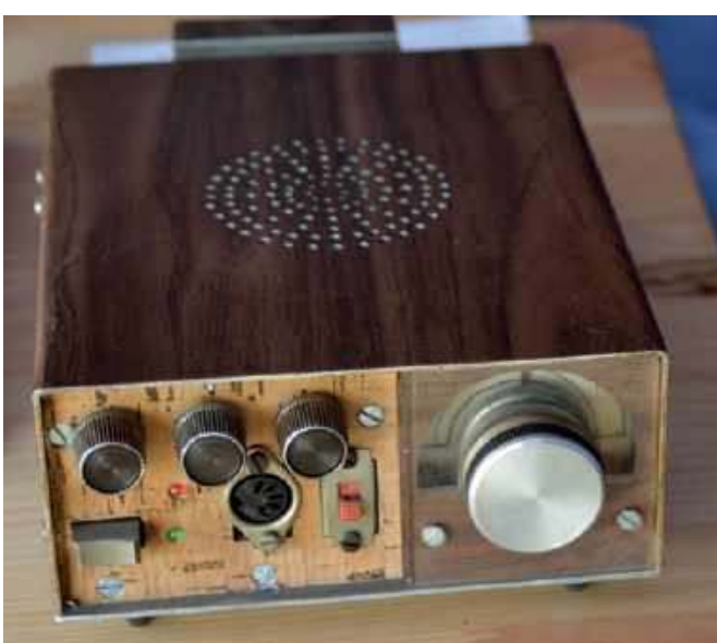
TRX Bartkopodobny (fazowo-homodynowy), wykonany pod koniec ubiegłego wieku przez SP9BW; obecny właściciel SQ9HHU
