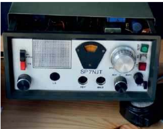
TRX Bartek wykonany przez SP7NJT w obudowie od TRX Żuraw
