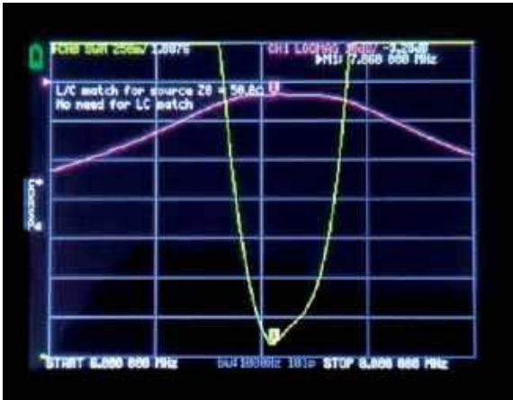
Dopasowanie filtru do impedancji
