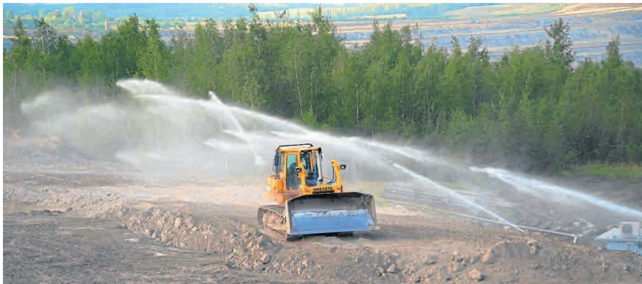
Poważnym problemem jest pylenie wyrobisk kopalni, które zanieczyszcza powietrze. Żeby je zmniejszyć, zamontowano zraszacze
