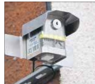
Czujnik informuje o aktualnym stężeniu pyłów zawieszonych PM 10, PM 2.5 i PM 1, odpowiedzialnych za jakość powietrza
