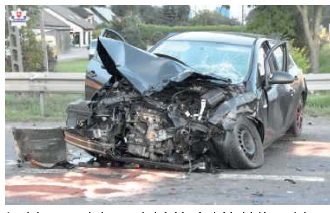
Auto było mocno uszkodzone, trzeba było jak najszybciej odpiąć i usunąć akumulator
