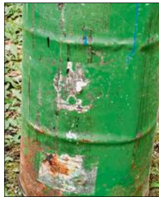
W beczce znajdowała się zanieczyszczona woda z rdzą wraz z pozostałością po rozpuszczalniku lub farbie olejnej.
