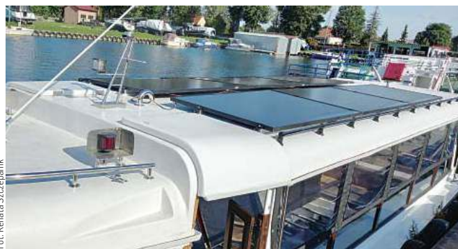
„Arka”, statek kupiony od armatora z Zalewu Czorszyńskiego koło Nidzicy, który do niedawna pływał na silniku tradycyjnym, spalinowym. Dziś pływa dzięki słońcu i panelom fotowoltaicznym
