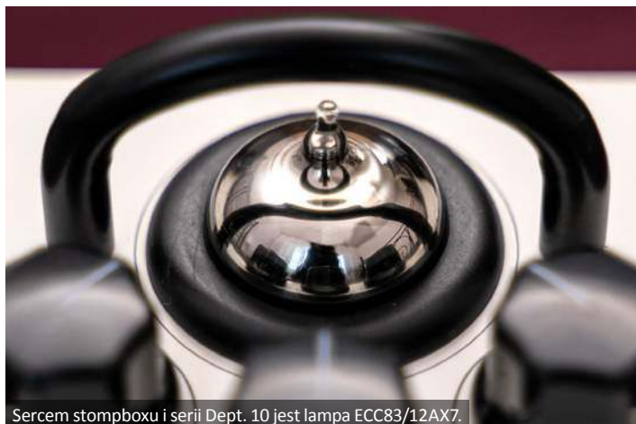
Sercem stompboxu i serii Dept. 10 jest lampa ECC83/12AX7.
