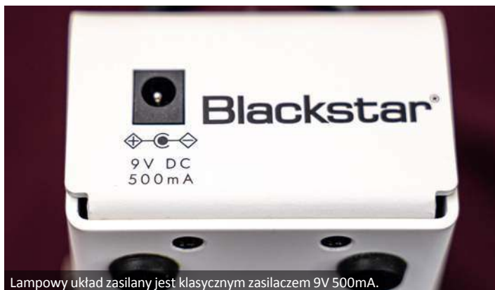
Lampowy układ zasilany jest klasycznym zasilaczem 9V 500mA.
