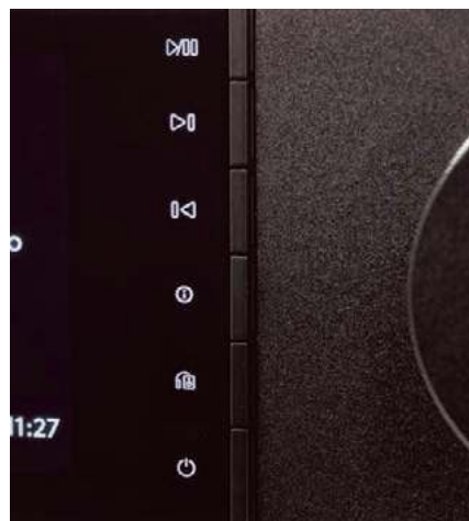
Pomiędzy pokrętłem a matrycą zainstalowano pionowy moduł „klasycznych” przycisków do obsługi podstawowych funkcji.
