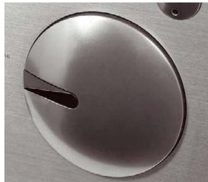
Pokrętko głośności prowadzi do typowego potencjometru.
