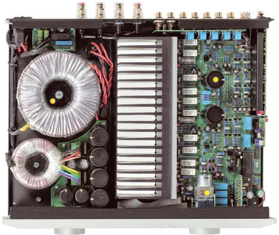
Widać dwie wyodrębnione sekcje – zasilacza oraz obwodów audio – rozdzielone radiatorem umieszczonym w centrum
