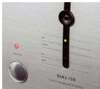
Aktywne wejście odczytamy z niewielkiego diodowego wskaźnika.
