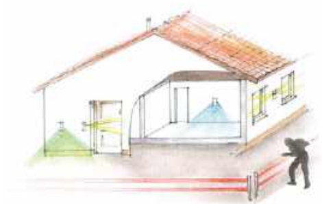
📌 Bariery podczerwieni lub czujki wstrząsowe już w linii ogrodzenia, czujki ruchu lub bariery w pobliżu budynku, zabezpieczenia wewnątrz domu – ochrona może być „wielowarstwowa”, jeżeli poziom zagrożenia jest wysoki.
