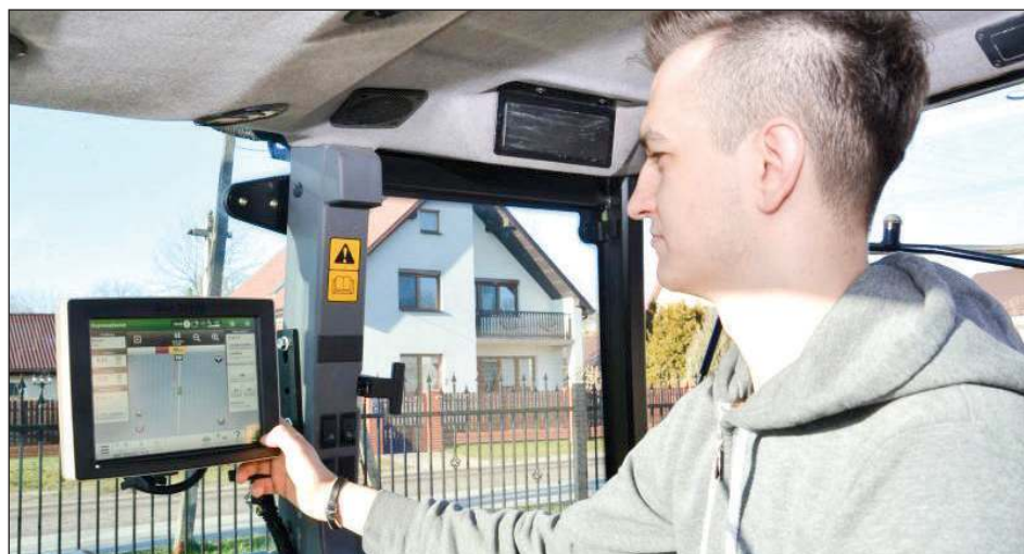
■ Urządzenie pozwala na automatyczne prowadzenie ciągnika z dokładnością od 15 do 3 centymetrów, w zależności od poziomu odbieranego sygnału GPS oraz wdrażanie nowoczesnych technologii rolnictwa precyzyjnego w zakresie nawożenia, siewu nasion i ochrony roślin
