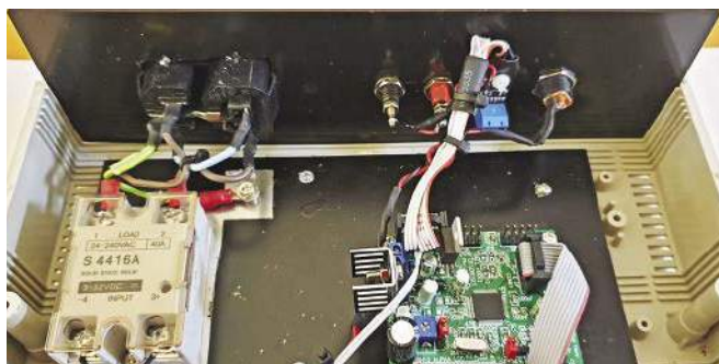
Widok połączeń na tylnym panelu – ponownie przypominamy, że jest to widok przed założeniem osłony izolacyjnej z prespanu. Nie zapomnij o niej! Użycie czerwonej opaski termokurczliwej na żółto-zielonym przewodzie uziemienia jest złamaniem wszystkich zasad dobrej praktyki warsztatowej!
