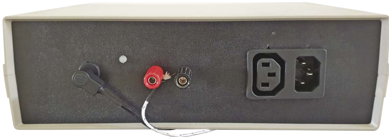
Na tylnej ścianie znajduje się gniazdo wejściowe 9 V DC (po lewej), a obok niego dedykowane zaciski termopary. Na prawym końcu znajduje się podwójne przyłącze sieciowe IEC: wejściowe i wyjściowe, które jest sednem tego projektu; sieć zasilająca dochodzi do prawego (męskiego) wtyku; nadzorowane/stereowane zasilanie do piekarnika tostowego pobierane jest z lewego (żeńskiego) gniazda.
