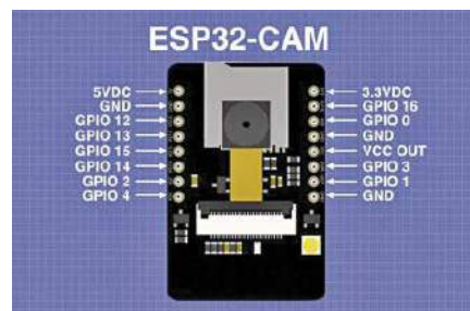
Rysunek 3. Szczegóły wyprowadzeń modułu ESP32
