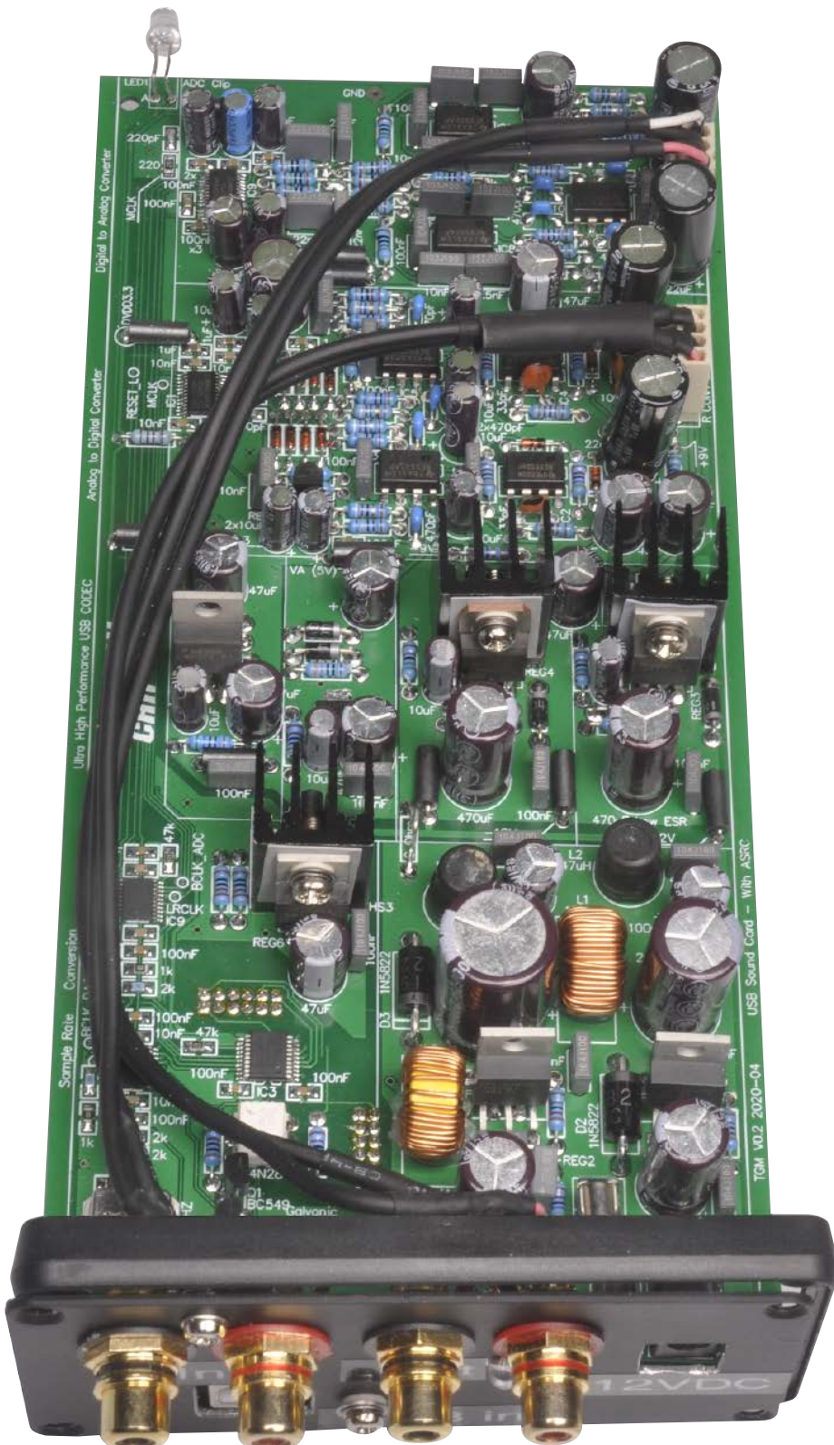
Do budowy przejdziemy w przyszłym miesiącu, jak już skończymy ten dość skomplikowany opis. Dla zaostrezenia apetytu, oto gotowa płytka drukowana zmontowana z gniazdami wejścia/wyjścia RCA, pokazana w naturalnej wielkości.
