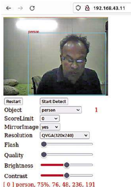
Rysunek 6. Wyjście obrazu z kamery pokazuje detekcję osoby oraz dostępne atrybuty obrazu
