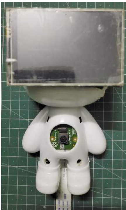
Rysunek 5. Umieszczenie kamery w „ciele” robota
