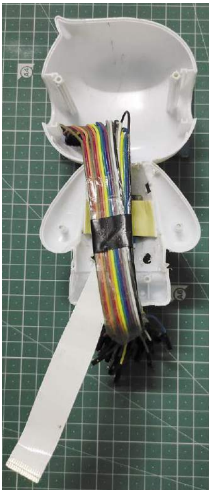
Rysunek 6. Okablowanie łączące ekran robota
