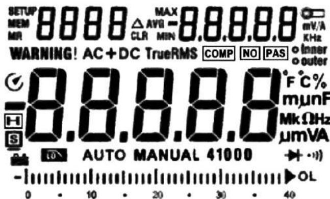
Specjalny wyświetlacz LCD cyfrowego miernika uniwersalnego z różnymi symbolami (© 2018 Jos Verstraten)
