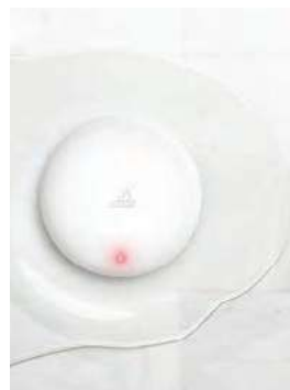
➊ Różne rodzaje czujek: magnetyczna kontaktronowa (a SATEL), dualna, zbudowana z czujnika podczerwieni PIR i mikrofalowego (b SATEL) – te są antywłamaniowe oraz czujka zalania (c FIBARO).
