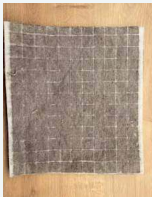
🔌 Filtr po miesięcznej eksploatacji.
