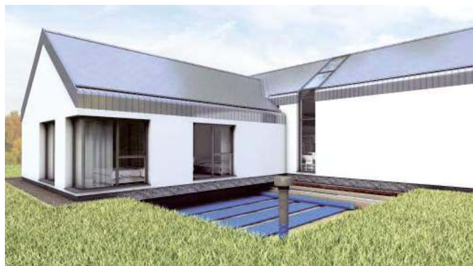
🔌 GWC umożliwia wykorzystanie gruntu do ogrzewania powietrza w zimie, a chłodzenia latem. PRO-VENT
