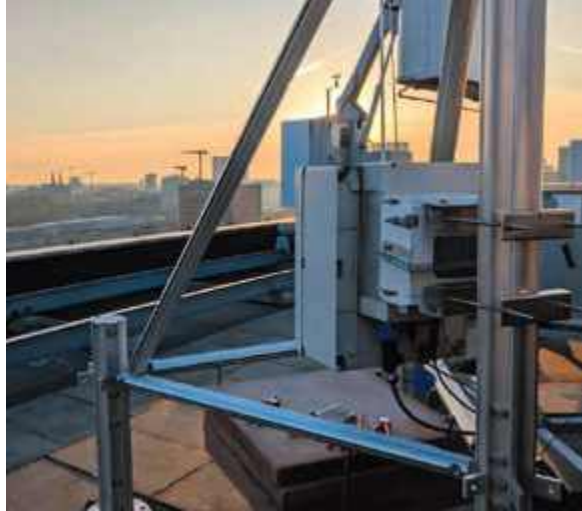
Fragment anteny optycznej do transmisji w paśmie podczerwieni (Eindhoven)
