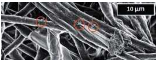
Struktura grzybni (fotografia SEM). W kółkach bakterie mineralizujące
