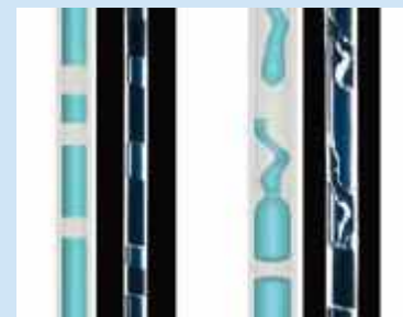
Woda przepływająca porcjami przez cienkie rurki (przepływ tłokowy) wywoływała efekt elektrostatyczny.
