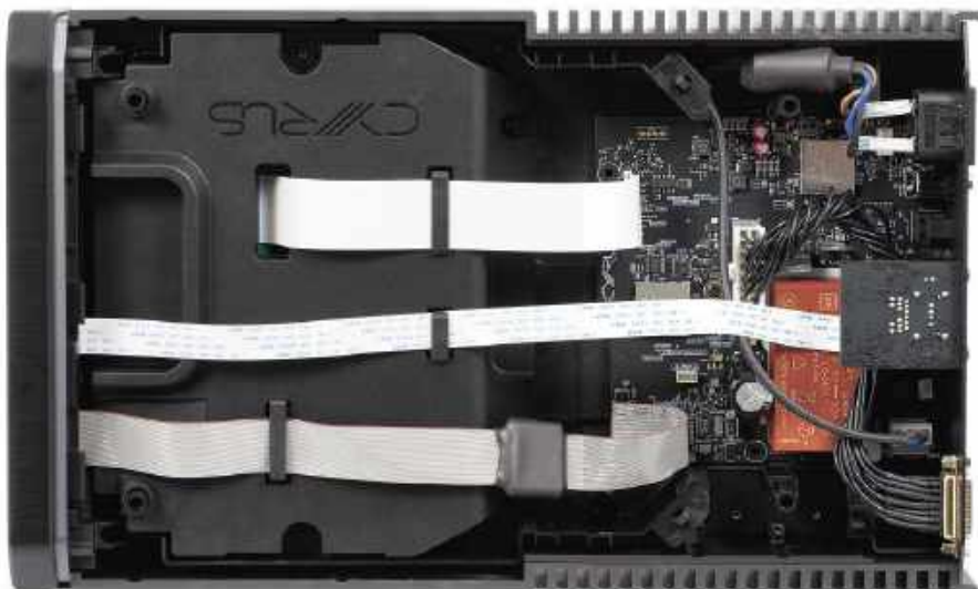
Mechanizm CD zajął większą część obudowy, elektronika znajduje się w tylnej części.
