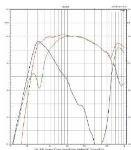
Rys. 2. Charakterystyki źródeł niskich częstotliwości.
