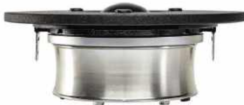
Magnes neodymowy to cienki plaster, dość blisko frontu głośnika; metalowa część poniżej jest wyfrezowaną w aluminium komorą wytłumiającą.
