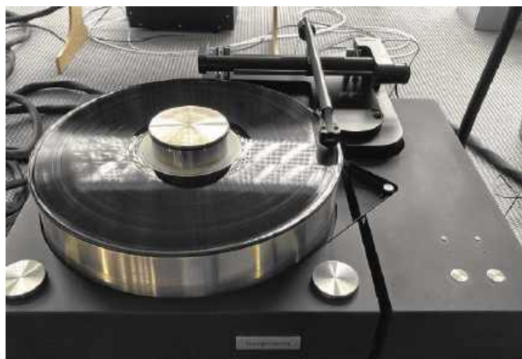
Gramofon Galdor-Odin Signature duńskiej firmy Bergmann również ma talerz unoszący się na poduszce powietrznej. Płyta jest wypłaszczana przez pompę próżniową, poprzez wysysanie powietrza, co „przykleja” całą powierzchnię płyty do talerza. Przy okazji poznajemy tzw. ramię tangencjalne (liniowe) i jesteśmy urzeczni skandynawskim ascetyzmem.
