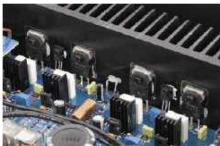
Końcówki mocy składają się z dwóch par tranzystorów bipolarnych Toshiba..
