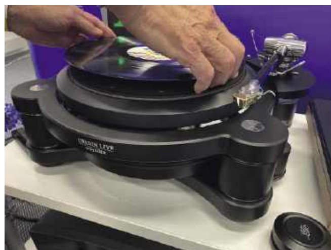
Voyager to najlepszy gramofon Origin Live; w wersji S (na zdjęciu), wprowadzonej 2 lata temu, dodano więcej warstw tłumiących, poprawiono zasilacz, łożysko i talerz; jego charakterystyczna konstrukcja ma rozprzyszczyć rezonanse samej płyty winylowej.
