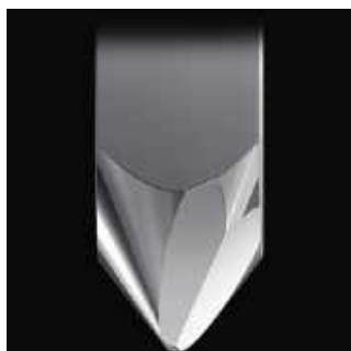
Igły o profilu Shibata, stworzone pierwotnie dla płyt kwadrofonicznych, doskonale służą płytom stereofonicznym.
