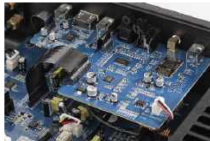
Układy cyfrowe zajmują dwie dodatkowe płytki; jedna to przetwornik C/A, druga obsługuje gniazdo HDMI.
