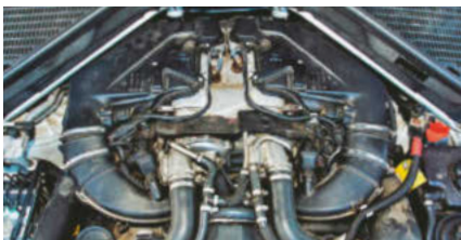
TURBOSPŘĘŻARKI pomiędzy głowicami mają dodatkowe chłodzenie cieczą. Ale i tak generują mordercze dla silnika temperatury.
