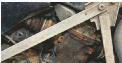
DYFERENCJAŁ też miał zmieniany olej. Tu nie było problemów, ale czasami dyferencjały zaczynają wyć. Sporo firm je regeneruje.
