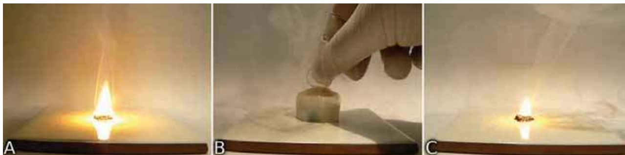
Fot. 4 – Spalanie fosforu czerwonego; A – po zapłonie, B – ugaszenie poprzez odcięcie dopływu powietrza, C – samozapłon pod wpływem powietrza
