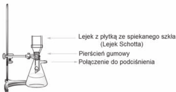
Rys. 3. Zestaw do sączenia pod zmniejszonym ciśnieniem.
