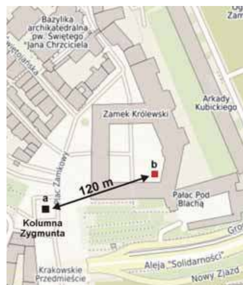
Rys. 4. Przesunięcie współrzędnych geograficznych między systemem WGS-84 (punkt a – rzeczywiste położenie Kolumny Zygmunta) a układem Pułkowo'42 (b), opracowanie na podstawie: polska.e-mapa.net
