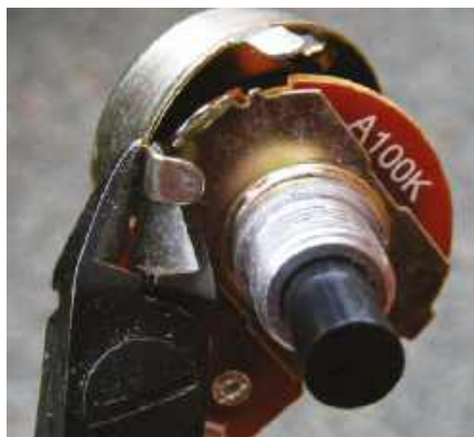
Rysunek 1. Najlepszym sposobem na zapoznanie się z budową potencjometru jest jego rozłożenie na części. Większość obudów potencjometrów jest po prostu zaciśnięta. Wystarczy odgiąć zaczepy za pomocą cęgów bocznych
