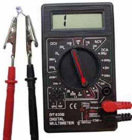
Fotografia 3. Sprawdzanie diody LED za pomocą multimetru ustawionego na funkcję testowania diod. Po przytoczeniu sondy czerwonej do anody, a czarnej do katody, sprawna dioda LED powinna się zaświecić. Jeśli dioda ma odpowiednio długie (jeszcze nie przycięte) wyprowadzenia można się wspomóc krokodylkami
