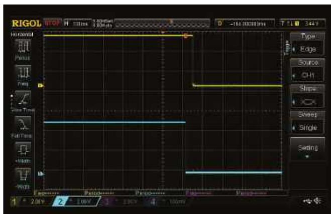
Rysunek 8. Enkoder o 30 kliknięciach. Z lewej: obrót pokrętła o jeden klik w lewo, po prawej: kolejny klik w lewo
