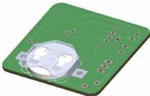
Rysunek 11. Bateria wsunięta do uchwytu. Górna powierzchnia baterii to jej biegun dodatni, który ma stykać się z blaszkami uchwytu
