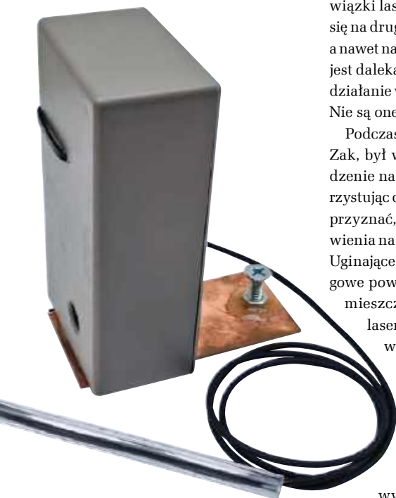
Fotografia 1. Obudowa nadajnika jest stosunkowo niewielka. Śruba regulacyjna służy do ustawiania wysokości wiązki laserowej. Po ustawieniu wysokości można łatwo i precyzyjnie regulować azymut wiązki
