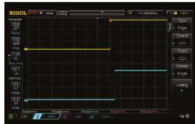
Rysunek 7. Enkoder o 30 kliknięciach. Z lewej: obrót pokrętła o jeden klik w prawo, po prawej: obrót o kolejny klik w prawo
