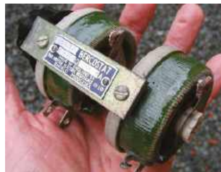
Rysunek 2. Najstarszymi regulatorami głośności były potencjometry drutowe. Oto nietypowy, podwójny potencjometr o dużej mocy, służący do regulacji poziomu wysterowania głośnika wysokotonowego
