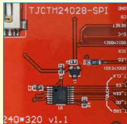
Rysunek b i c. Moduł LCD z panelem dotykowym w wersji V1.1 przed (po lewej) i po (po prawej) wymianie rezystora R6 na element o wartości 110 Ω, w celu zmniejszenia prądu podświetlenia
