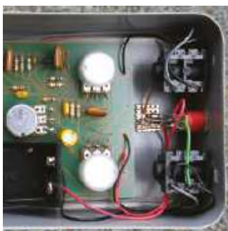
Rysunek 5. Zastosowanie potencjometrów Alpha stanowi ekonomiczne i skuteczne rozwiązanie. Na zdjęciu są widoczne wersje 16 mm, używane w gitarowym pedale Colorsound Silver Tonebender
