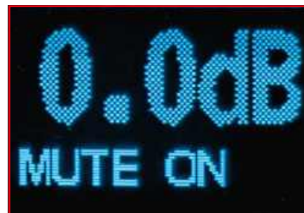
Ekran 2. Wygląd wyświetlacza modułu OLED przy włączonej lub wyłączonej funkcji MUTE. Jeśli wyświetlane są trzy kreski, oznacza to, że moduł OLED nie odbiera danych z modułu sterującego
