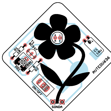
Rysunek 2. Schemat montażowy układu. Uchwyt baterii to element do montażu powierzchniowego (SMD), który należy zamontować po stronie lutowania, pozostałe elementy do montażu przewlekanych (THT) należy zamontować po stronie przeciwnej
