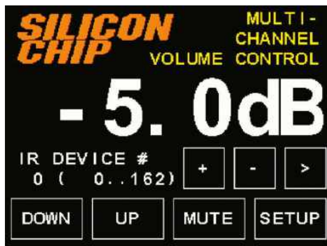
Ekran 3. Ekran konfiguracji z obszarem przeznaczonym do wyświetlania parametrów konfiguracyjnych oraz przyciskami sterującymi. Aby wyświetlić ten ekran i rozpocząć konfigurację, naciśnij i przytrzymaj przycisk SETUP przez pięć sekund
