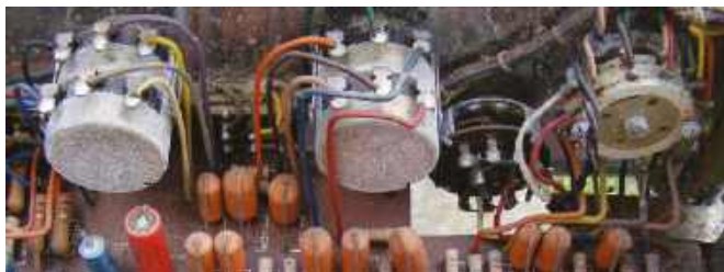
Rysunek 3. We wczesnych urządzeniach Hi-Fi stosowano potencjometry ze ścieżką węglową firmy Morganite. Znalazły one zastosowanie we wzmacniaczu Leak Stereo 30 z 1964 roku, zbudowanym na tranzystorach germanowych. Nadal działają pomimo utlenienia i zabrudzeń
