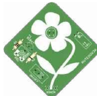
Rysunek 4. Rezystory o odpowiednich wartościach, oznaczone za pomocą kodu kolorowych pasków, zamontowane na właściwych pozycjach, zgodnie z listą elementów
