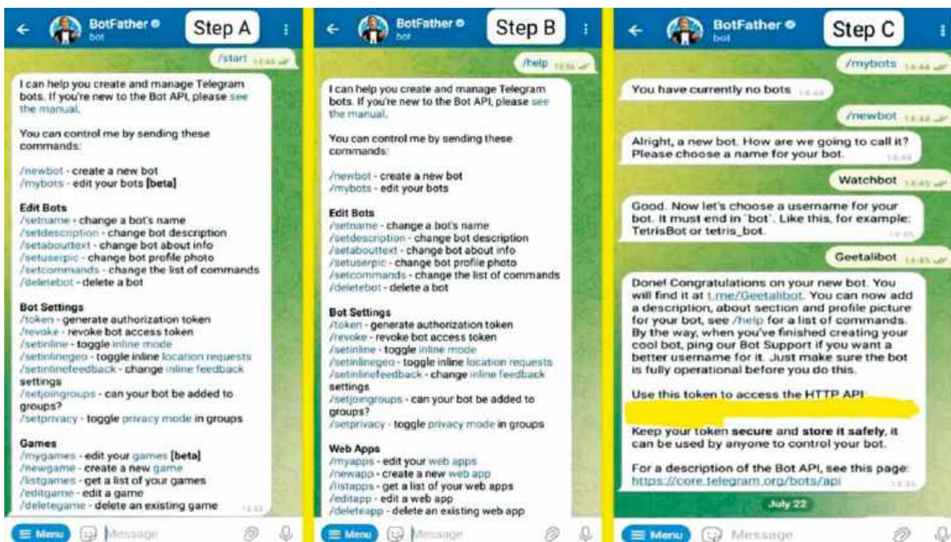
Rysunek 6. Uruchamianie bota Telegram i uzyskiwanie klucza API
