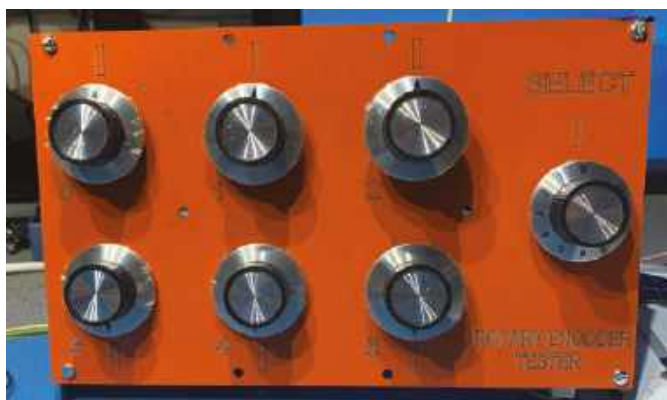
Rysunek 6. Stanowisko testowe do badania sześciu różnych enkoderów obrotowych. Zdjęcie: Joe Farr
