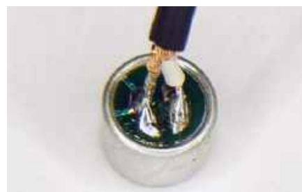
Fotografia 4. Na fotografii pokazano sposób przyłutowania ekranowanego przewodu do mikrofonu elektretowego. Oplot ekranu jest przyłutowany do pola lutowniczego połączonego z obudową mikrofonu
