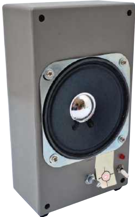
Fotografia 2. Obudowa odbiornika pełni jednocześnie funkcję przegrody głośnikowej. Karteczka samoprzylepna z narysowanym celem jest istotnym elementem, ponieważ ułatwia celowanie i rozprasza światło lasera, dzięki czemu ustawienie łącza jest znacznie łatwiejsze (dobrze sprawdza się również taśma maskująca)
