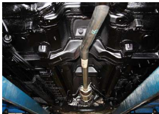
Podwozie zabezpieczone antykorozyjnie
