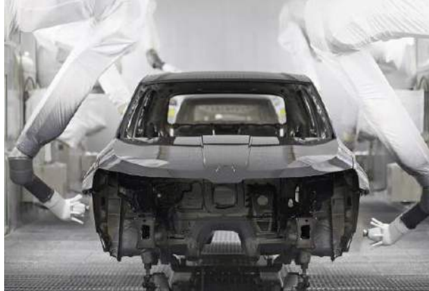
Nakładanie kolejnej warstwy lakieru przez roboty
