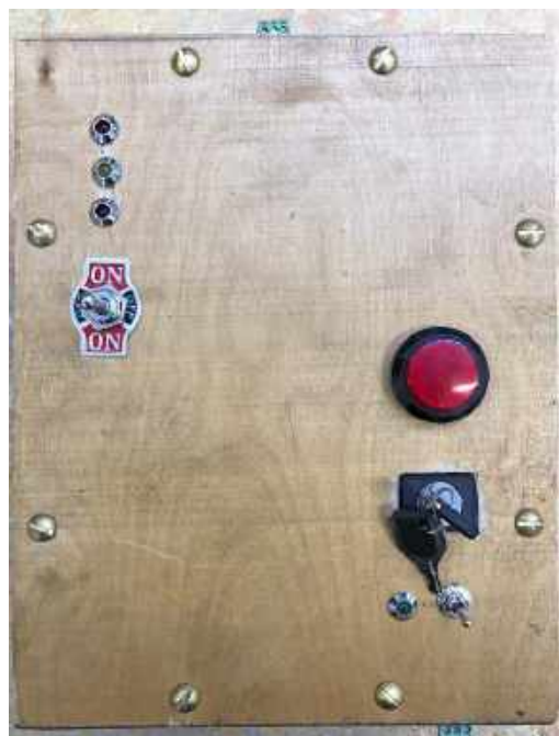
4. Zmontowany i zamknięty w obudowie kontroler – gotowy do startu
