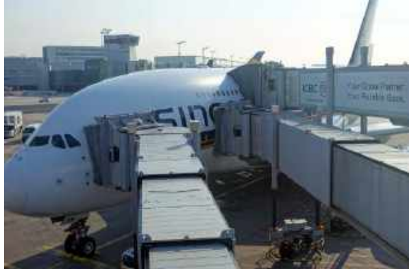
2. A380 podczas tzw. boardingu z trzema kołnierzami dla wsiadających pasażerów
