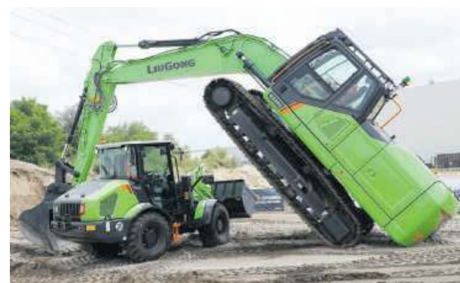
Mniejsza z maszyn to elektryczna ładowarka typ 820TE, druga – elektryczna koparka 922FE
