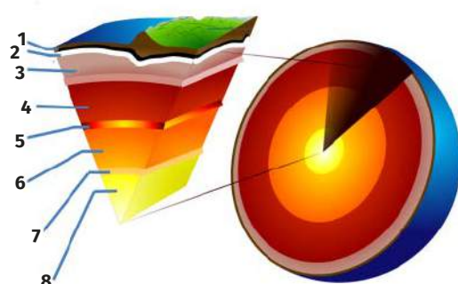
2. Warstwy wewnętrzne Ziemi, według współczesnej wiedzy: 1) Skorupa, 2) Nieciągłość Mohorovičića (Moho), 3) Górny płaszcz, 4) Dolny płaszcz, 5) Strefa D, 6) Jądro zewnętrzne, 7) Granica pomiędzy materiałem ciekłym a stałym, 8) Jądro wewnętrzne
