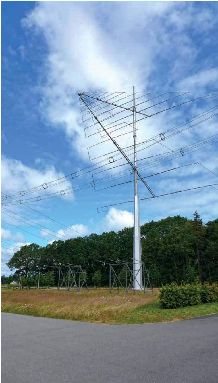
Logarytmiczno-periodyczna antena krótkofalowa radiostacji Grimeton (fot. Marcin Madej). Konstrukcja systemu antenowego, który współpracowałby z nadajnikiem, pozostaje kwestią dyskusyjną
