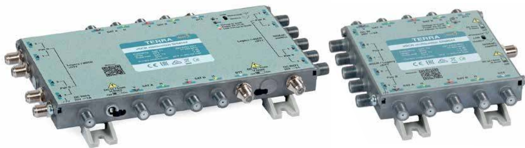
Multiswitch SRM-584 R80584 i SRM-544 R80584 R80544 Terra serii dSCR/Unicable są wyposażone w przełączniki On/Off umożliwiające przesłanie zasilania DC 20 V w liniach sygnałowych H/V (dwa złącza DC IN służą do podłączenia zasilacza DC 20 V R71468)
