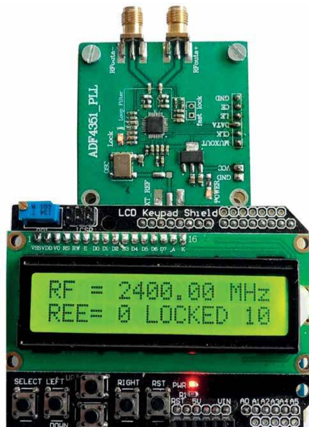
Rys. 8. Generator sygnału testowego – moduł ADF4351 sterowany przez Arduino Uno
