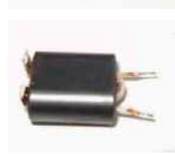
Transformator wejściowy TR1 (zdjęcia pochodzą z Internetu)
