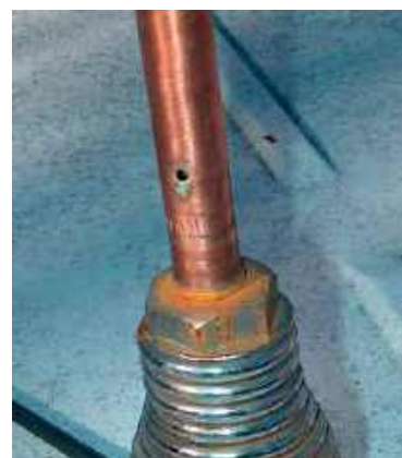
Mocowanie anteny na sprężynie. Otwór w rurce zapewnia odpływ gromadzącej się wody
