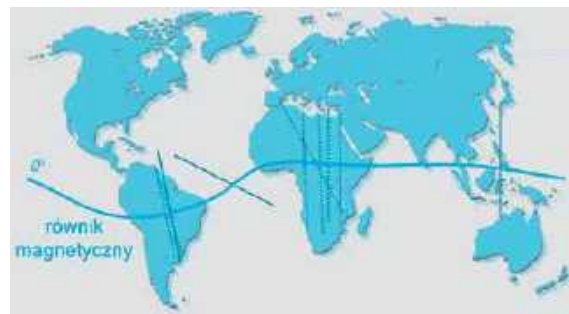
Rys. 4. Równik magnetyczny nie pokrywa się z równikiem geograficznym i przebiega po linii falistej. Na ilustracji zaznaczono najczęstsze trasy łączności. Falisty przebieg równika magnetycznego powoduje, że mogą one być odchylone od kierunku północ-południe nawet o 45 stopni. Stacje położone na większych szerokościach geograficznych mogą korzystać z łączności TEP, jeśli pomiędzy nimi a rejonem wokół równika znajdują się chmury Es dające dodatkowe odbicia (źródło [3])
