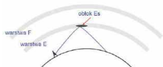
Rys. 1. Odbicie fali od zjonizowanych obłoków warstwy sporadycznej Es, w korzystnych konstelacjach mogą wystąpić odbicia wielokrotne
