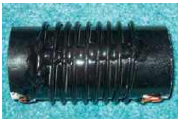
Szczegóły konstrukcyjne cewki na pasmo 18 MHz
