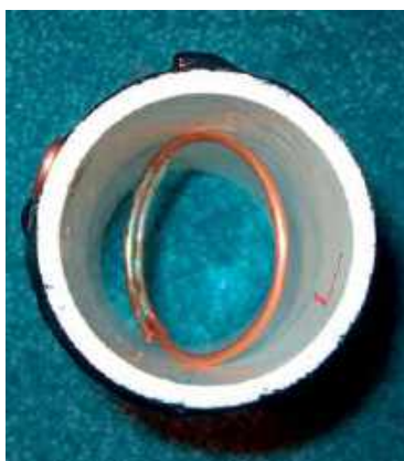
Pierścień strojący wewnątrz cewki na pasmo 7 MHz jest wykonany z rurki miedzianej, strojenie cewki polega na jego obracaniu. Może okazać się niepożądany albo przydatny tylko w niektórych pasmach
