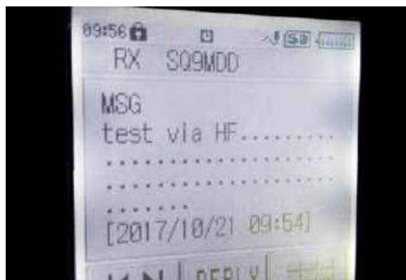
Przesyłanie wiadomości APRS HF na APRS VHF
