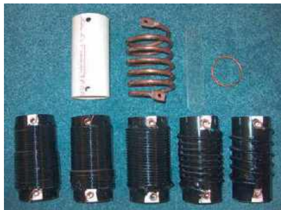
W dolnym rzędzie widoczne są cewki dla pasm 160, 80, 40, 20 i 17 m, a w górnym korpus do nawijania cewek, poprzednio używana cewka na pasmo 10 m wykonana z rurki instalacyjnej 1/4 cala i omówiony w tekście wspornik plastikowy
