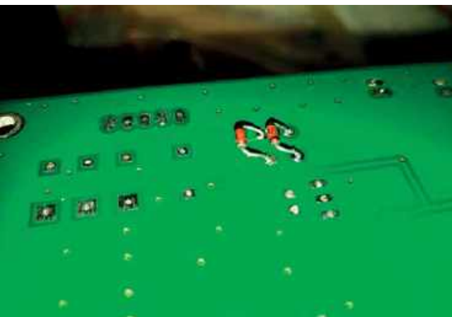
Diody układu stabilizacji prądu spoczynkowego
