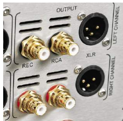
Wśród wejść są zarówno RCA, jak i XLR-y; te ostatnie zapewniają najlepsze rezultaty, bowiem FLS9 to wzmacniacz w pełni zbalansowany.
