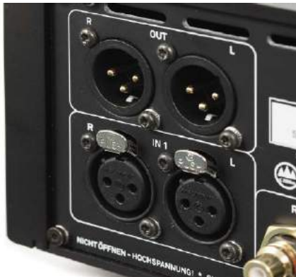
A 200 przyjmuje sygnały zbalansowane, które może też przesłać dalej – do kolejnego wzmacniacza mocy (w systemie bi-amping).
