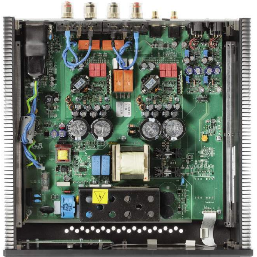
A 200 to klasyczna konstrukcja w klasie D, w pełni analogowa, sygnał jest prowadzony w takiej postaci od wejścia do wyjścia, również modulator w sekcji wyjściowej pracuje w formule analogowej.
