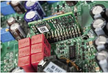
Ta niewielka płytka to moduł Eigentakt firmy Purifi Audio, układ 1ET400A.
