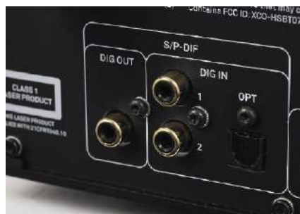
Oprócz wyjścia współosiowego są też wejścia cyfrowe – elektryczne i optyczne.
