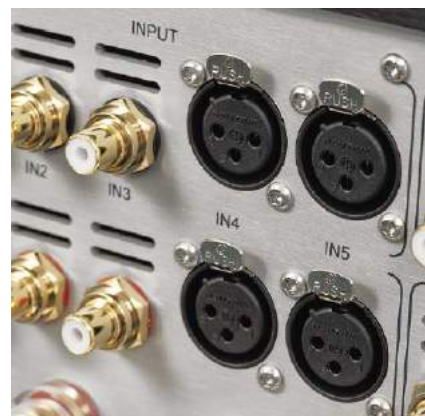
Gniazda XLR pojawiają się też w roli wyjść. W serii FLS dostępna jest końcówka mocy.
