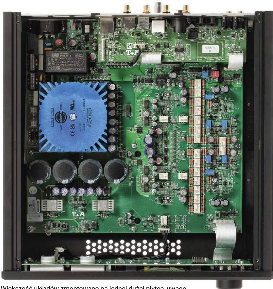
Większość układów zamontowano na jednej dużej płytce, uwagę zwraca duży zasilacz liniowy.
