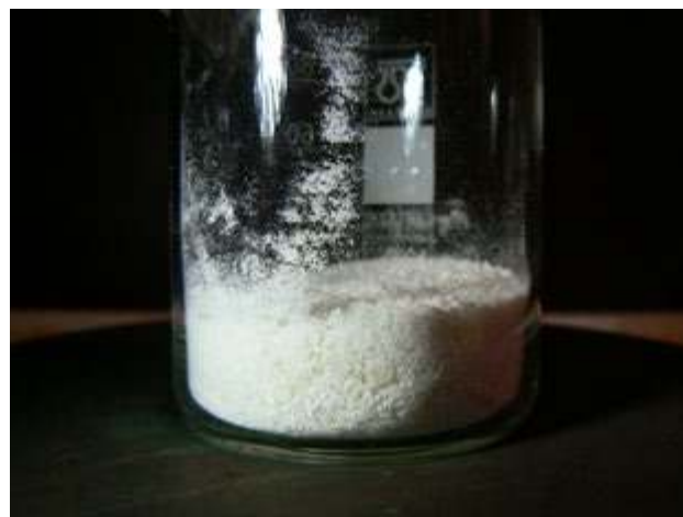
Zgodnie z metodą Radziszewskiego powinniśmy teraz energicznie mieszać ciecz bagietką. Wprowadziłem tutaj jednak pewną prostą, ale ważną innowację, która nieco zwiększa efektywność metody. Zamiast mieszać ciecz zastosowałem napowietrzanie. Do gorącego hydrobenzamidu wprowadziłem szklaną pipetę pasteurowską, przez którą dostarczałem sprężone powietrze.
