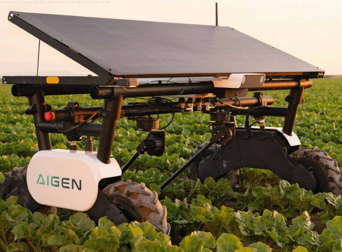
Robot pielęgnacyjny z napędem solarnym
