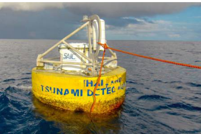
Boja wykrywająca fale tsunami
