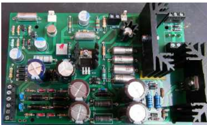
Rysunek 2. Płytkę zasilacza z poprzedniego odcinka w stanie poprawionym. Jest na niej tylko sześć „mokrych” kondensatorów elektrolitycznych Nichicon. Wszystkie pozostałe mniejsze kondensatory spolaryzowane są typu stałego. Zmniejszyło to tętnienia resztkowe w liniach zasilania \pm 15\text{ V} o 50%, a w linii zasilania „fantom” o 75%. Oczekiwany czas życia kondensatorów wynosi teraz 40 000 godzin w temperaturze +75^\circ\text{C} . Koszt tej modernizacji wyniósł około 75zł, ale koszt robocizny i przestoju związany z wymianą „mokrego” kondensatora byłby znacznie wyższy
