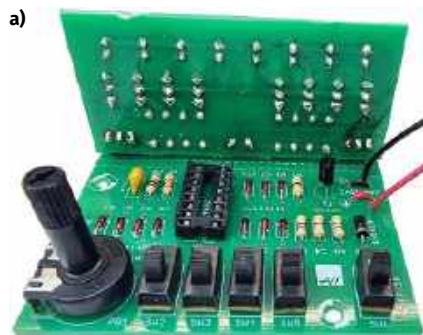
Fotografia 25. Poprawnie zmontowany stroboskop. Widok a) płytki sterującej od strony komponentów oraz płytki wykonawczej od strony lutowania, b) płytki sterującej od strony lutowania oraz c) płytki wykonawczej od strony elementów
