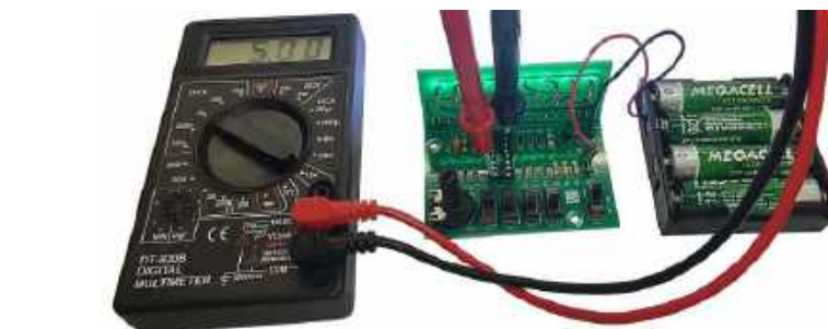
Fotografia 27. Pomiar na zaciskach 16 („plus”) i 8 („minus”) podstawki pod układ scalony wskazał poprawne napięcie baterii (bez znaku „-”, który sugerowałby błędną polaryzację). Można odłączyć zasilanie i zamontować układ scalony w podstawce
