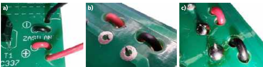
Fotografia 22. Kabelki złącza baterii należy a) przeprowadzić przez otwory pomocnicze od strony komponentów, następnie b) patrząc „od spodu” przełożyć je przez kolejną parę otworów, i na końcu c) przylutować odizolowane i pocynowane wcześniej końcówki kabelków do odpowiednich pól lutowniczych na płycie PCB
