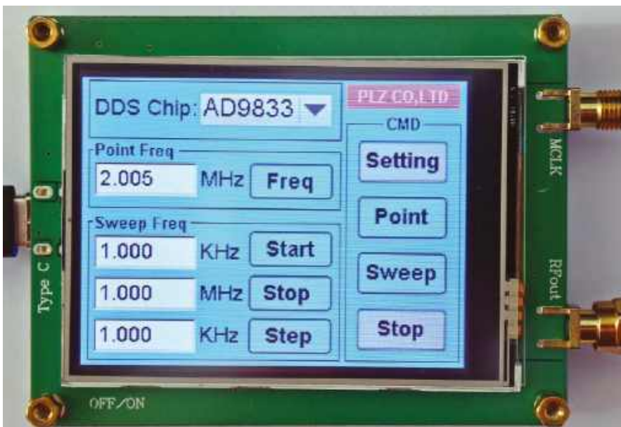
Rysunek 6.15. Programowane źródło przebiegów oparte na układzie AD9833, mogące stanowić podstawę prostych przyrządów pomiarowych jak np. generatory sygnałów, generatory funkcji i wobulatory
