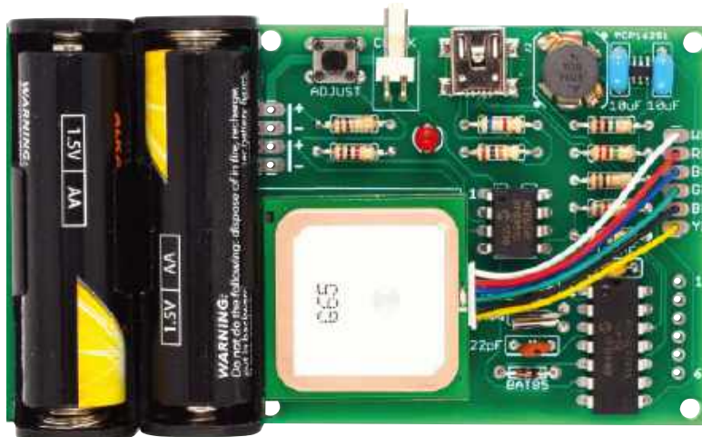
W pełni zmontowana płytka drukowana sterownika. Dotykowy przetwornik do regulacji sekundnika znajduje się w pobliżu górnej krawędzi, obok złącza USB do konfiguracji oprogramowania układowego. W prawym górnym rogu znajduje się cewka i inne elementy związane z przetwornicą, która zapewnia napięcie 4 V dla modułu GPS
