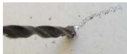
Rysunek 14. „Wędrówki” wiertła można uniknąć, wcześniej punktując otwór
