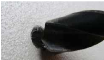
Rysunek 17. Małe otwory można sfazować wiertłem o większej średnicy
