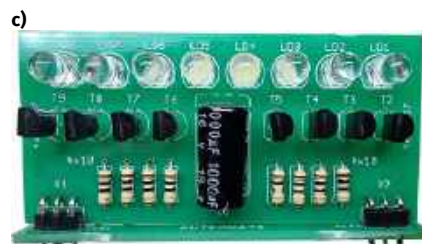
Fotografia 25. Poprawnie zmontowany stroboskop. Widok a) płytki sterującej od strony komponentów oraz płytki wykonawczej od strony lutowania, b) płytki sterującej od strony lutowania oraz c) płytki wykonawczej od strony elementów
