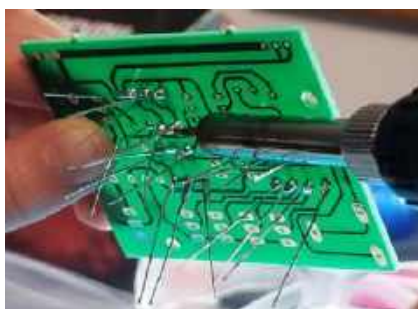
Fotografia 8. Nadmiar cyny na padach lutowniczych może powodować zwarcia między sąsiednimi wyprowadzeniami komponentów. Aby je usunąć, wystarczy ponownie podgrzać luty i odpowiednio manewrować grotem lutownicy, umożliwiając nadmiarowi cyny spłynięcie. Ilustracja przedstawia właściwą technikę
