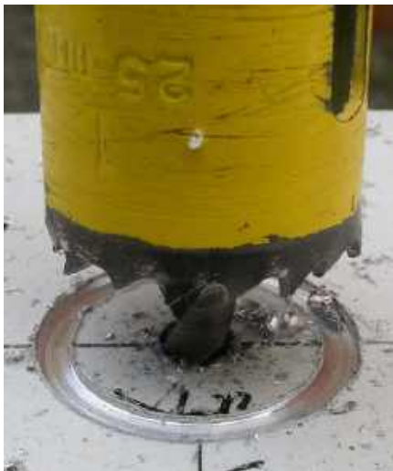
Rysunek 27. Wycinanie dużych okrągłych otworów, np. dla złączy XLR, ząbkowanym wycinakiem
