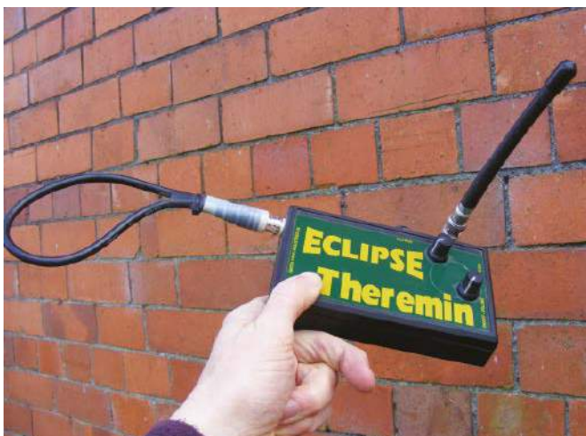
Rysunek 39. Anteny typu „gumowa kaczka” dla przenośnych środków łączności są dobrymi antenami do małych Thereminów. Są one zazwyczaj odłączalne dzięki podstawom z wtykami BNC.
