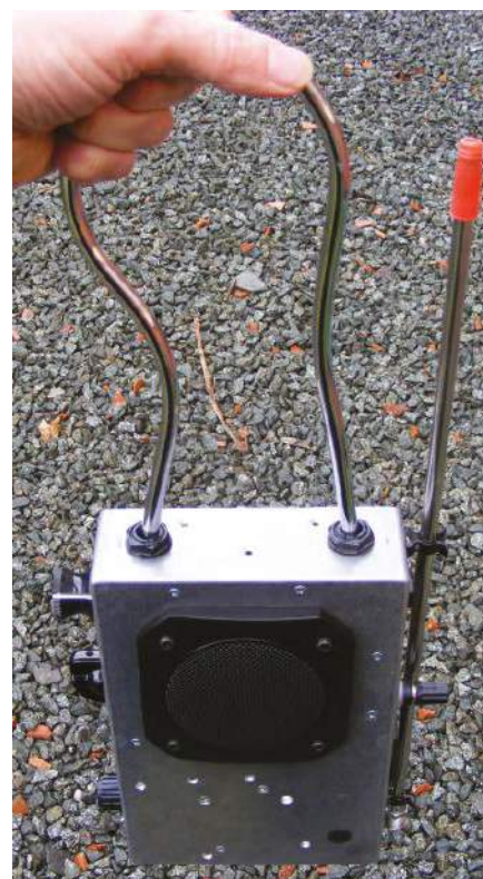
Rysunek 41. Pętla głośności Theremina pełni rolę uchwytu.
