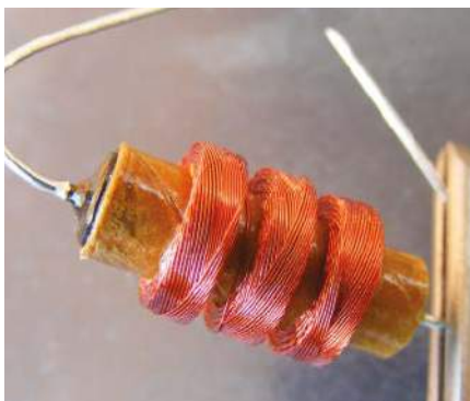
Rysunek 43. Cewki firmy Miller Bourns mają minimalną pojemność własną i stanowią doskonałe cewki obciążeniowe.
