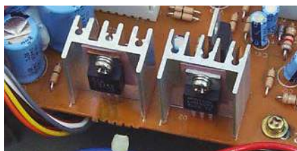
Rysunek 7.4. Dwa trójnóżkowe stabilizatory napięcia wyposażone w radiatory montowane na płytce drukowanej.
