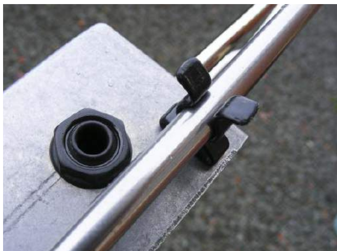
Rysunek 40. Użyj klipsów na narzędzia do przechowywania odłączanych anten podczas transportu Theremina.
