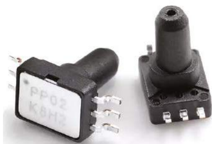
Czujnik ciśnienia 2SMPP-02 wykrywa niewielką zmianę ciśnienia przy dotknięciu płytki naciskowej. Nie trzeba zbyt wielkiego nacisku, aby go uruchomić – wystarczy dotknięcie, gdy nawracasz do następnego przepłynięcia basenu.
