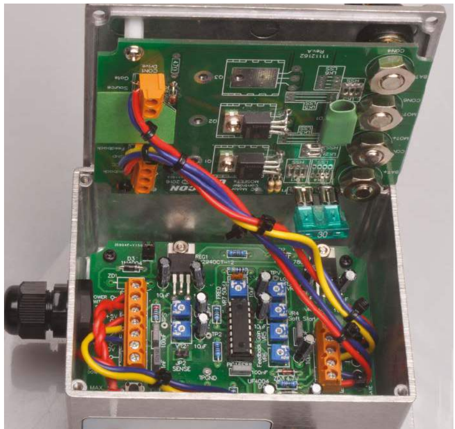
Wnętrze regulatora prędkości obrotowej silnika – kompletne szczegóły budowy zostaną przedstawione w przyszłym miesiącu, ale będą się nieco różnić od tego prototypu. Połączenia na płytce drukowanej MOSFET-ów zostały ustawione do pracy w trybie przetaczania po stronie zasilania.
