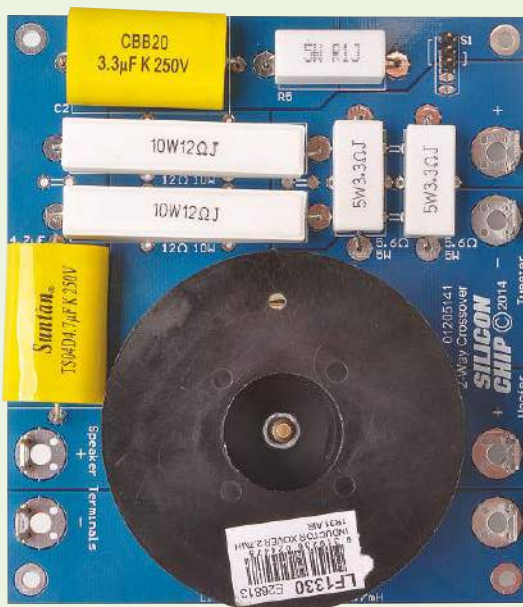
Rysunek 1. Schemat ideowy zwrotnicy jest stosunkowo prosty, zawiera ona przede wszystkim cewkę L1 działającą jako filtr dolnoprzepustowy dla głośnika niskotonowego i kondensator 4,7 μF jako filtr górnoprzepustowy dla głośnika wysokotonowego. Pary rezystorów R1 i R2 tłumią sygnał wysokotonowy, żeby poziom jego odtwarzania został dopasowany do efektywności głośnika niskotonowego. Pozostałe komponenty tworzą przełączany układ podbicia najwyższych dźwięków.
