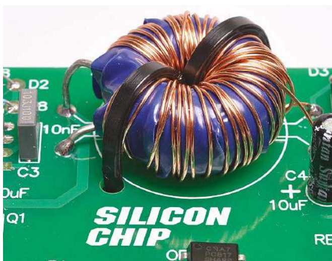
Z powodu braku gotowego transformatora nawinęliśmy własny transformator na bazie gotowej cewki toroidalnej 100 µH/5 A. Po zaizolowaniu uzwojenia taśmą nawinęliśmy uzwojenie wtórne o identycznej ilości zwojów jak uzwojenie pierwotne.
