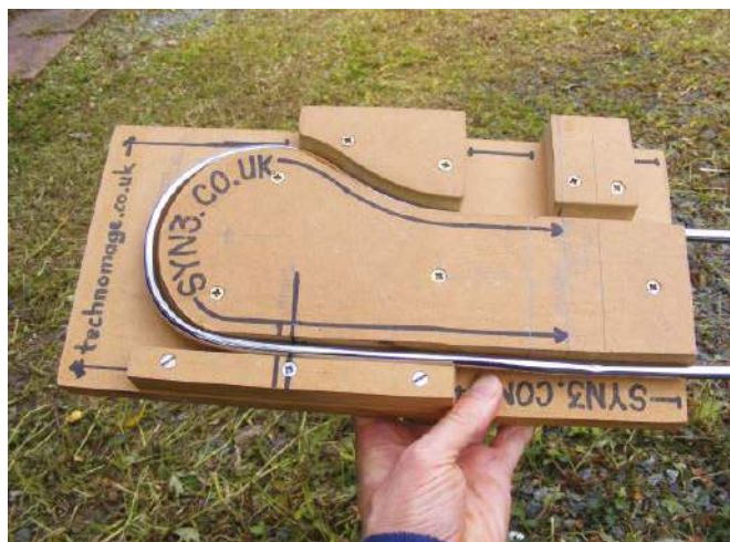
Rysunek 38. Aby wykonać dobre zagięcia w rurkach pętli głośności, bardzo pomocny jest prosty przyrząd – zaprojektowany przez Granta Stevensa dla Theremin.co.uk
