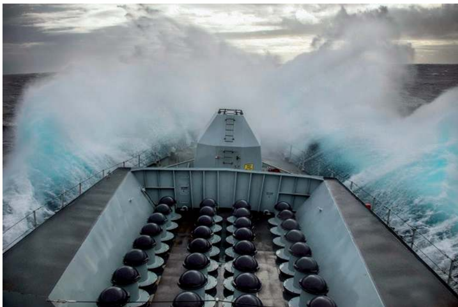
▲ Dobrze widoczne wyrzutnie systemu Sea Ceptor na fregacie HMS Lancaster typu 23. To właśnie tego typu rozwiązanie, zbieżne z wariantem lądowym, ma być wykorzystane także na okrętach brazylijskiej floty, co nieś ma określone korzyści logistyczne, eksploatacyjne i operacyjne.
