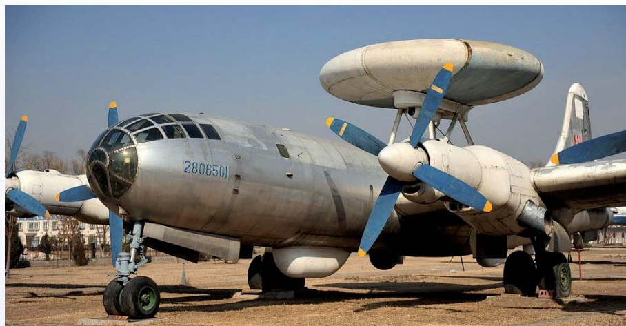
▲ Pierwszy chiński samolot dozoru radiolokacyjnego KJ-1 już jako eksponat w muzeum lotnictwa pod Pekinem. Samolot łączył płatowiec radzieckiej kopii B-29, silniki z transportowego An-12 i opracowaną lokalnie (nieudaną) osłonę radaru.
