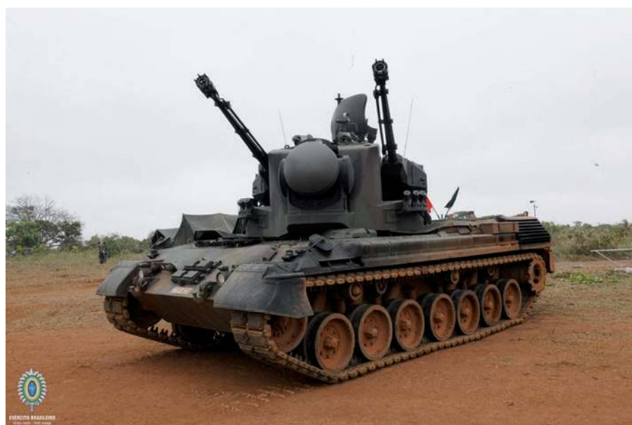
▲ Pochodzące z Niemiec „czołgi przeciwlotnicze” (Flugabwehrkanonenpanzer) uzbrojone w dwie armaty Oerlikon KDA kal. 35 mm tworzą baterie w niektórych brygadach Exército Brasileiro.
