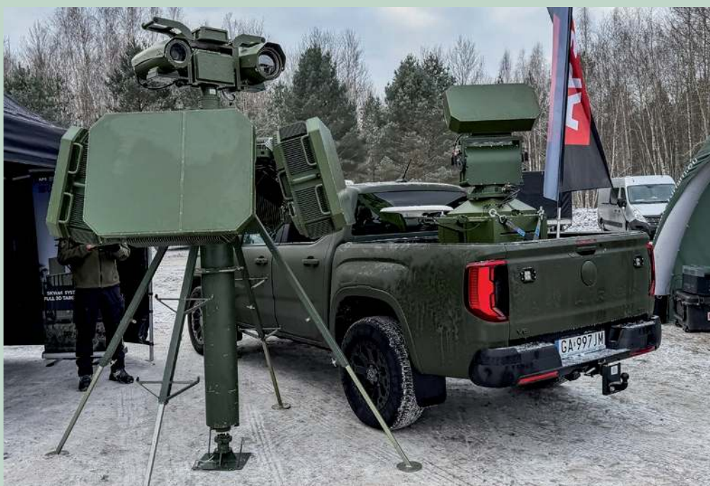
▲ Jednym z bardziej znanych projektów pozyskiwanych w dużej mierze dzięki SAFE jest system antydronowy San . Na zdjęciu zaplanowane do wykorzystania stacje FIELDctrl Ultra i FIELDctrl Follow opracowane i produkowane przez spółkę APS.
