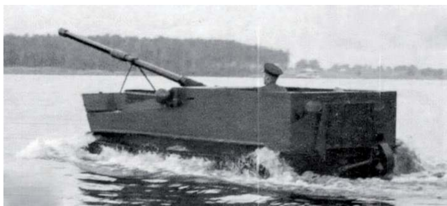
▲ ASU-57P (K-73) w trakcie testów związanych z pływaniem.
