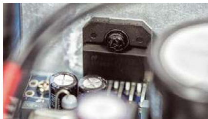
Końcówki mocy złożono z układów scalonych.
