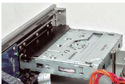
Mechanizm szczelinowy zaadaptowano z sektora komputerowego.
