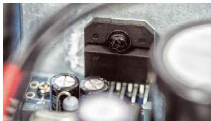
Końcówki mocy złożono z układów scalonych.
