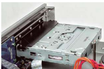
Mechanizm szczelinowy zaadaptowano z sektora komputerowego.
