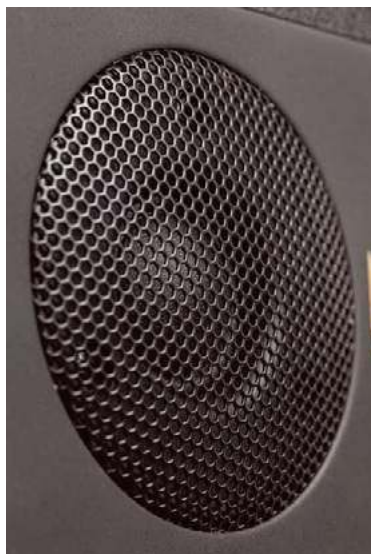
Kopułka wysokotonowa jest tekstylna, mimo to osłonięto ją metalowym grillem, typowym dla kopulek metalowych.
