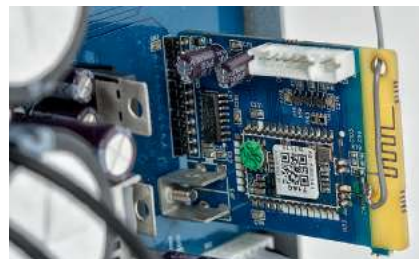
Moduł BT pochodzi z Audiolaba 6000A, antenę (cienkim, szarym przewodem) wyprowadzono na zewnątrz obudowy.
