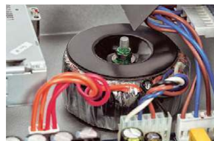
Dobre wrażenie robi rozbudowany, liniowy zasilacz z okazałym transformatorem toroidalnym.
