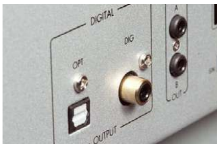
CDT to źródło cyfrowe w ścisłym tego słowa znaczeniu – wysyła tylko sygnał cyfrowy.
