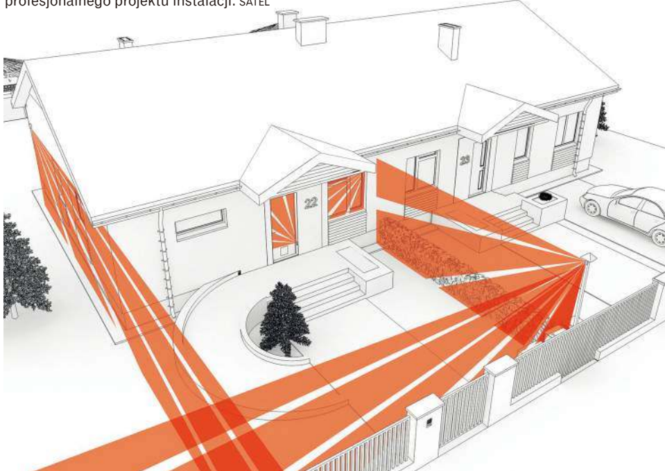
🔗 Zewnętrzne czujniki podczerwieni pasywnej. WEBER SYSTEMS
