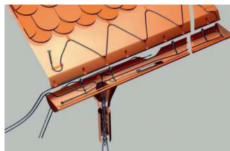
i i Zarówno rynny, jak i rury spustowe dobrze jest wyposażać w elektryczny system przeciwooblodzeniowy, który podczas mrozów zapobiega gromadzeniu się w nich lodu i śniegu. FENIX POLSKA, ELEKTRA
