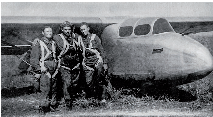
▲ Mały szybowiec desantowy G nr 4 z drugą osłoną kabiny zmniejszającą nasłonecznienie wnętrza lub wykorzystywanej do szkolenia w lotach przy złej widoczności. Obecność spadochroniarzy świadczy o udziale w szkoleniu skoczków.
