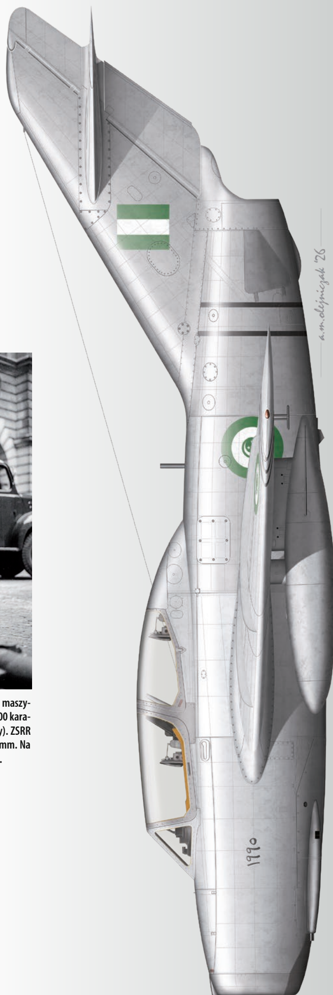
Samolot szkolno-bojowy CS-102 (licencyjny MiG-15UTI, produkowany w fabryce Středočeské strojírný, jeden z sześciu (nr 1990) kupionych przez Egipt w 1956 roku samolotów tego typu.
